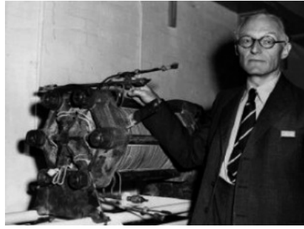
Figure II-4 : Francis Thomas Bacon et son prototype de pile à combustible de 5kW [BOU 12.]
