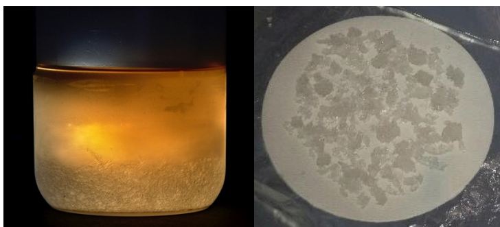
Figure III-1 : Photos de la solution commerciale initiale (à gauche) et des cristaux récupérés pour la préparation des différents clathrates.
