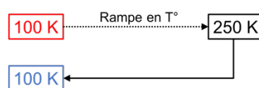
Figure V-9 : Cycle thermique suivi lors de l'acquisition des spectres Raman de l'échantillon \text{HPF}_{6.7,67}\text{H}_2\text{O} .
