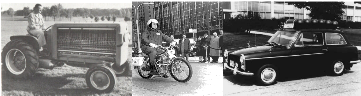
Figure II-6 : Les premières applications de la pile à combustible : le tracteur Allis-Chalmers alimenté par une pile à combustible (à gauche), la motocyclette Union Carbide équipée d'une pile AFC (au centre). L'Austin hybride de Karl Kordesch à pile à combustible alcaline (à droite) [BOU 12, REG 13].
