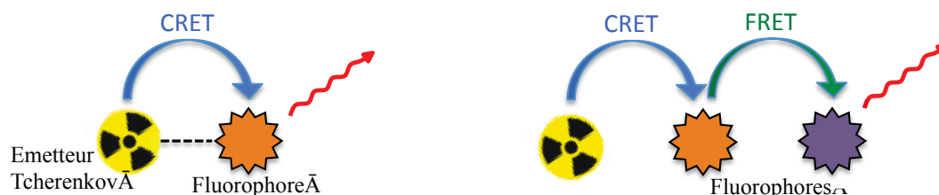
Figure 45 : Illustrations des phénomènes de CRET (gauche) et de CRET-FRET (droite)
