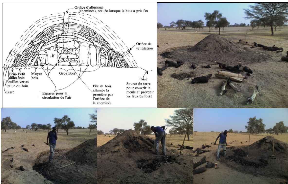
Figure 4.4 Schéma d'une meule à charbon en sable d'après Ribot, 1990, photo SEN_Z2_NIANING
