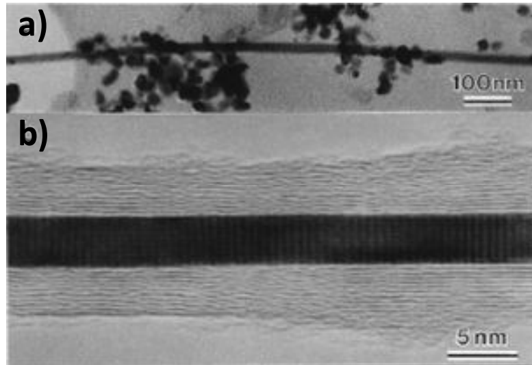
Figure I.24. (a) Image d'un nanofil de chrome encapsulé par l'ajout de soufre dans une proportion S/Cr = 0.5%at. (b) Agrandissement d'un nanofil montrant le caractère monocristallin du remplissage [DEM1999].
