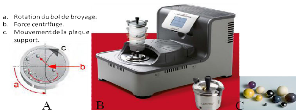
Figure III.6. Broyeur à billes. A) Principe de fonctionnement du broyeur, B) Photographie du broyeur planétaire premium line de l'équipe HP-HT du LSPM, et C) Billes de différentes nature et taille.
