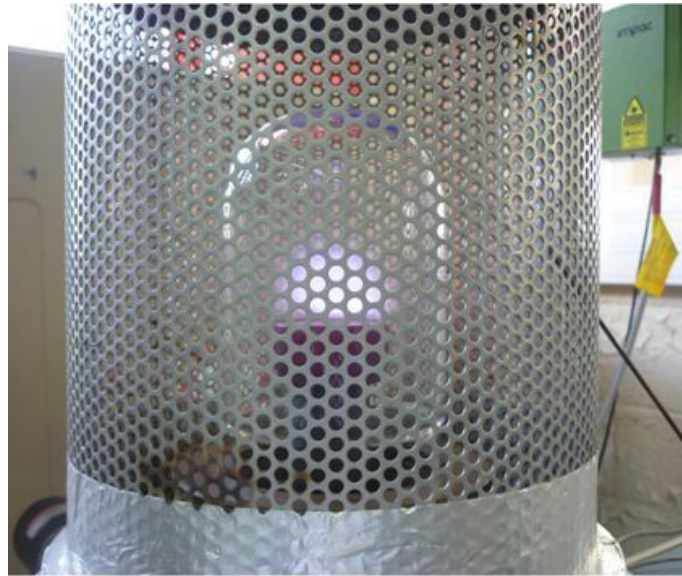
Figure II.24. Photographie du plasma lors de la synthèse de nanotubes par PECVD.
