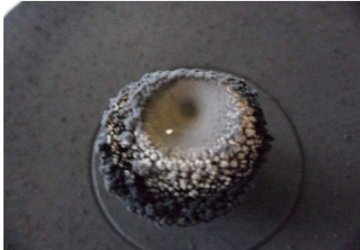
Figure II.9. Vue de dessus du dépôt gris formé sur la cathode après la synthèse.
