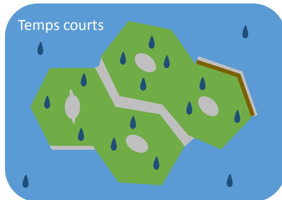
b) Endommagements interfaces et initiation de fissures dans certaines fibres (MEB) qui provoquent une chute de \sigma_{max} + « stockage » d'eau dans la matrice (DVS) qui induit une plastification de la matrice (mDSC) et une chute de module (traction).
