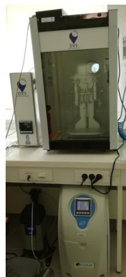
Figure 32 : Mesures DVS sur les fibres de lin et sur le composite lin/époxy (à gauche) et SMS DVS-Advantage (à droite).
