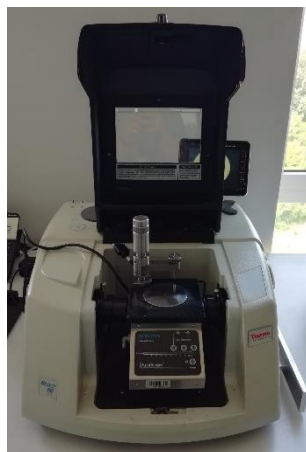
Figure 38 : Spectre typique obtenu en FTIR pour des fibres de lin non-vieillies (à gauche) et spectromètre Nicolet™ impact 380 (à droite).
