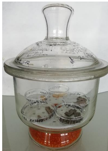
Figure 35 : Séchage à température ambiante des échantillons de résine et de composites vieillis.
