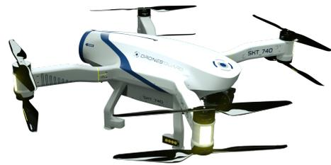
FIGURE 2.3 – Exemple d'un octaquadrotors Skeyetech. Copyright AzurDrones
