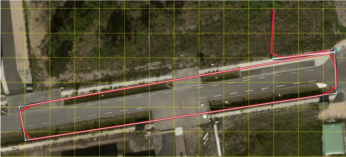
FIGURE 4.8 – Comparaison ancien contrôleur (en rouge) et nouveau contrôleur (en violet) sur un suivi de waypoints GPS (en blanc)
