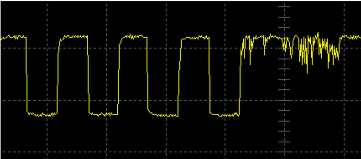
FIGURE 3.12 – Exemple de signal PWM bruité généré par une carte Linux.
