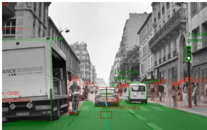
FIGURE 1.20 – Exemple des capacités de détection et classification d’une caméra frontale de Mobileye [Source : <https://www.mobileye.com/our-technology/>]
