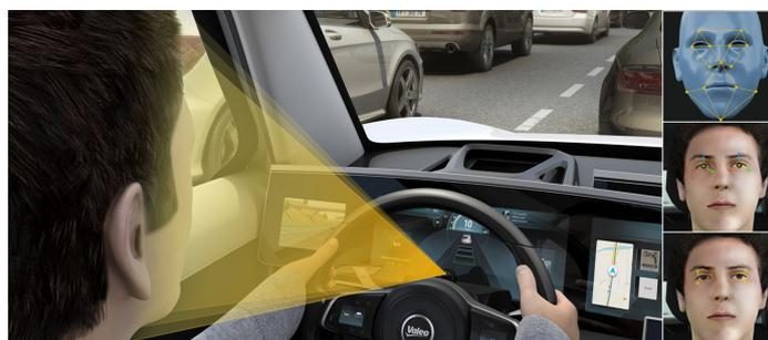
FIGURE 1.12 – Analyse de l'activité conducteur par la caméra de la fonction driver monitoring [Source : <https://www.valeo.com/fr/driver-monitoring/>]
