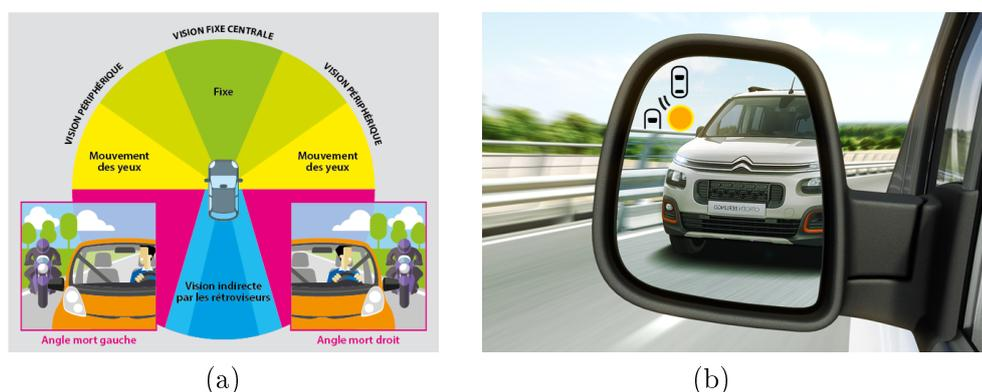
FIGURE 1.11 – Zones de visibilité et angles morts pour le conducteur (a) et indicateur lumineux du système de surveillance d'angles morts (b) [Sources : (a) <https://www.ornikar.com/code/cours/mecanique-vehicule/technologie-assistance/angle-mort>, (b) <https://www.citroen.be/fr/vehicules-neufs/citroen/new-citroen-berlingo/configurateur/couleurs-et-equipements/options.html>]
