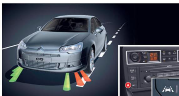
FIGURE 1.9 – Fonction alerte au franchissement de ligne [Source : [http://www.c5manuel.com/alerte\\_de\\_franchissement\\_involontaire\\_de\\_ligne-355.html](http://www.c5manuel.com/alerte_de_franchissement_involontaire_de_ligne-355.html)]
