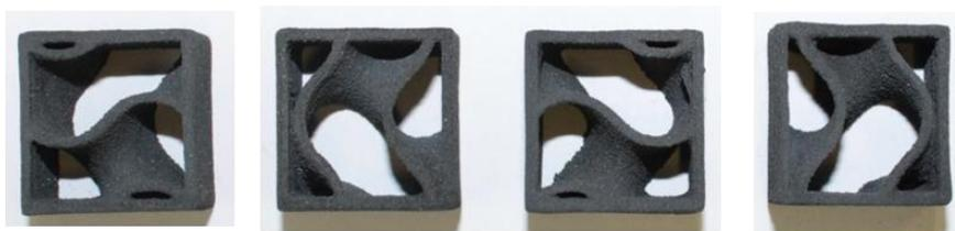
Figure 4.9 : 4 morceaux de la structure « Gyroïde » fabriqués (pas de renforcement par CVD/CVI).
