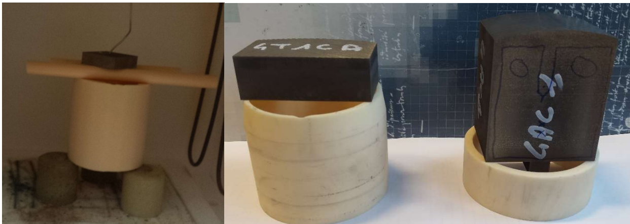
Figure 56 : Supports de traitements thermiques pour coupons de microstructure, ébauches d'éprouvettes de traction et ébauches d'éprouvettes CT.
