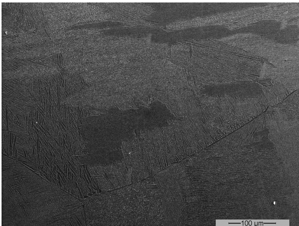
Figure 71 : Microstructure Ti54M avec maintien de 1h à Tβ+90°C.
