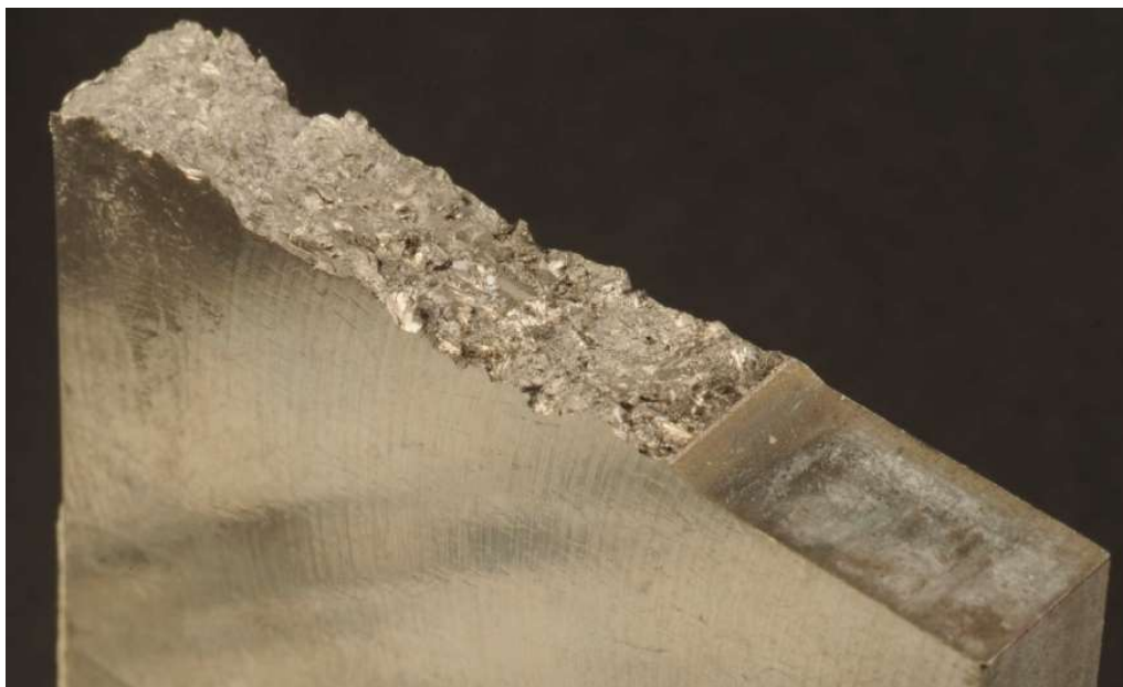
Figure 23 : Surface de fissure de l'alliage TA6V ELI traité \beta [45].
