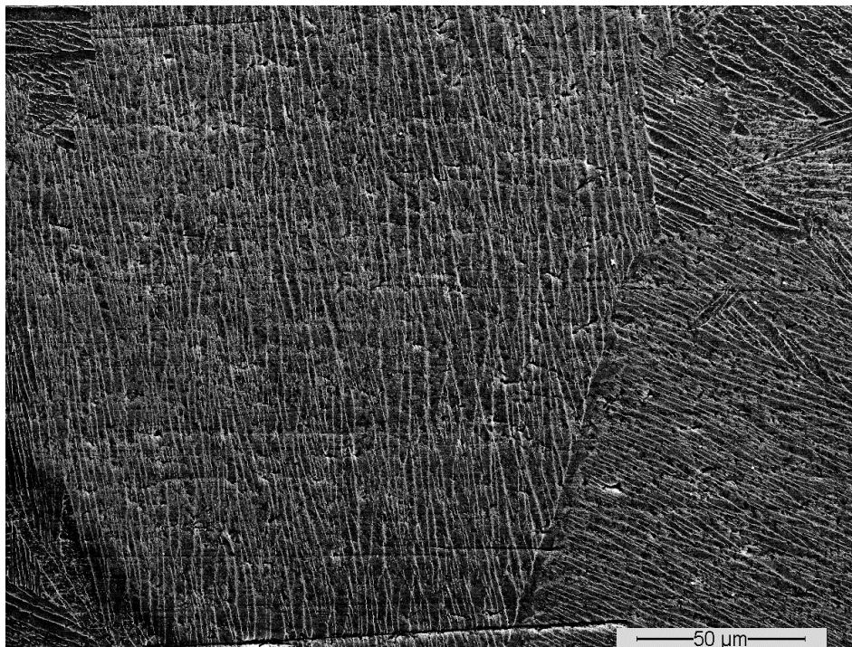
Figure 40 : Microstructure lamellaire du TA6V ELI coulée 306266C sur le plan C-R de la billette observée au MEB.
