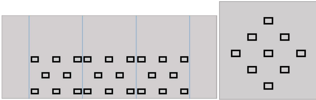
Figure 179 : positionnement des images MEB sur la surface à observer : sur une lamelle issue de l'ébauche d'une éprouvette CT à gauche, sur un coupon de microstructure à droite.
