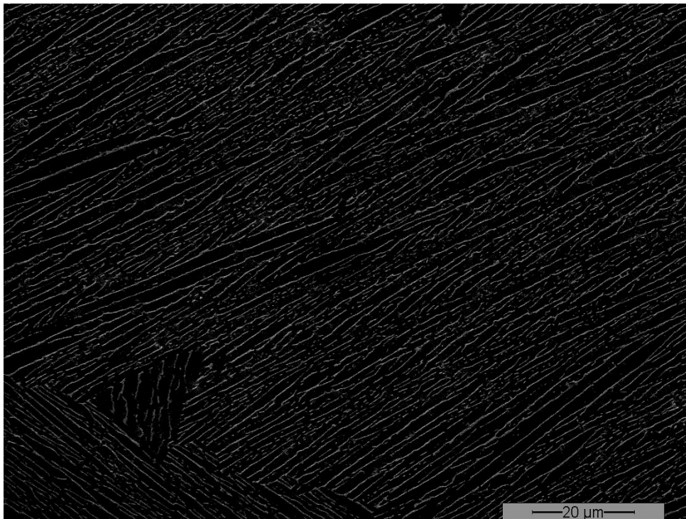
Figure 69 : Microstructure TA6V ELI avec maintien de 1h30 à T_{\beta}+75^{\circ}\text{C} .
