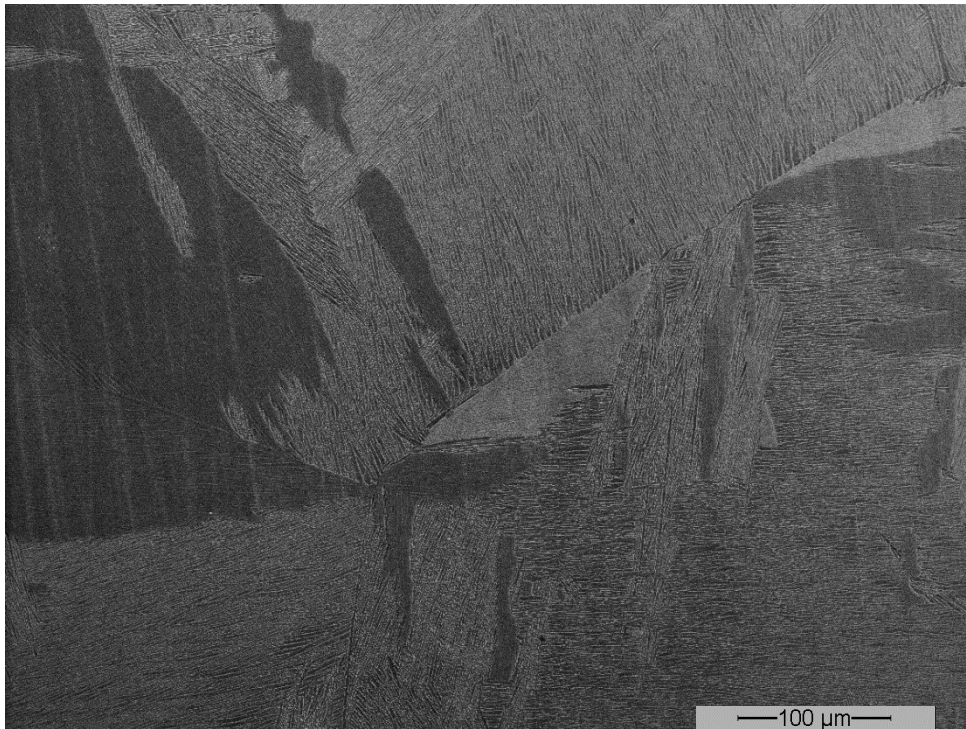
Figure 70 : Microstructure Ti54M avec maintien de 1h à Tβ+50°C.
