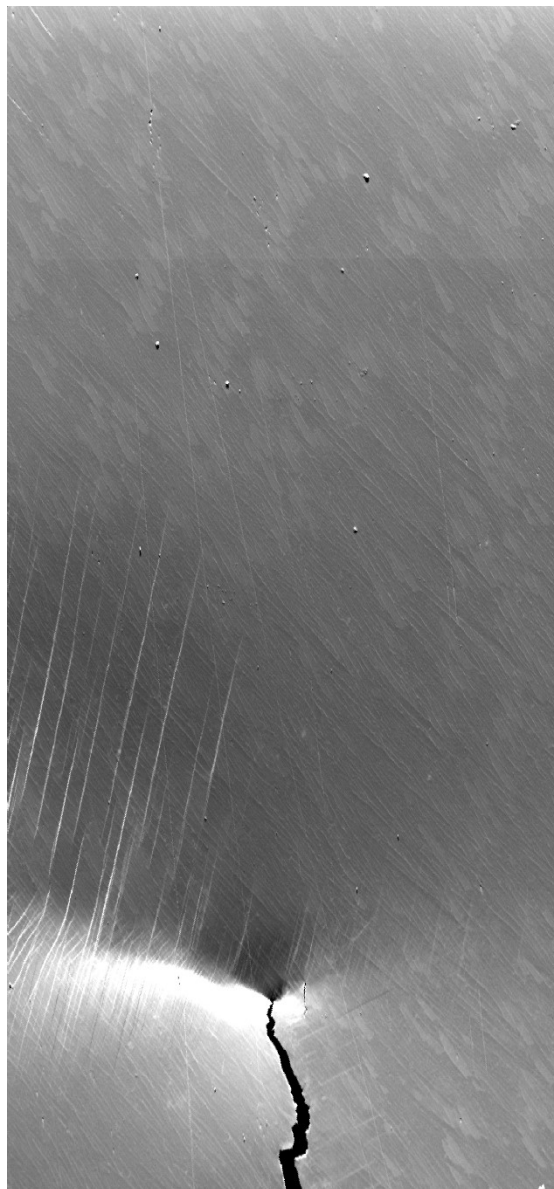
Figure 170 : Photo en électron rétrodiffusés lors de l'essai in-situ \Delta K 40 à K = 45\text{MPa}\sqrt{\text{m}} .
