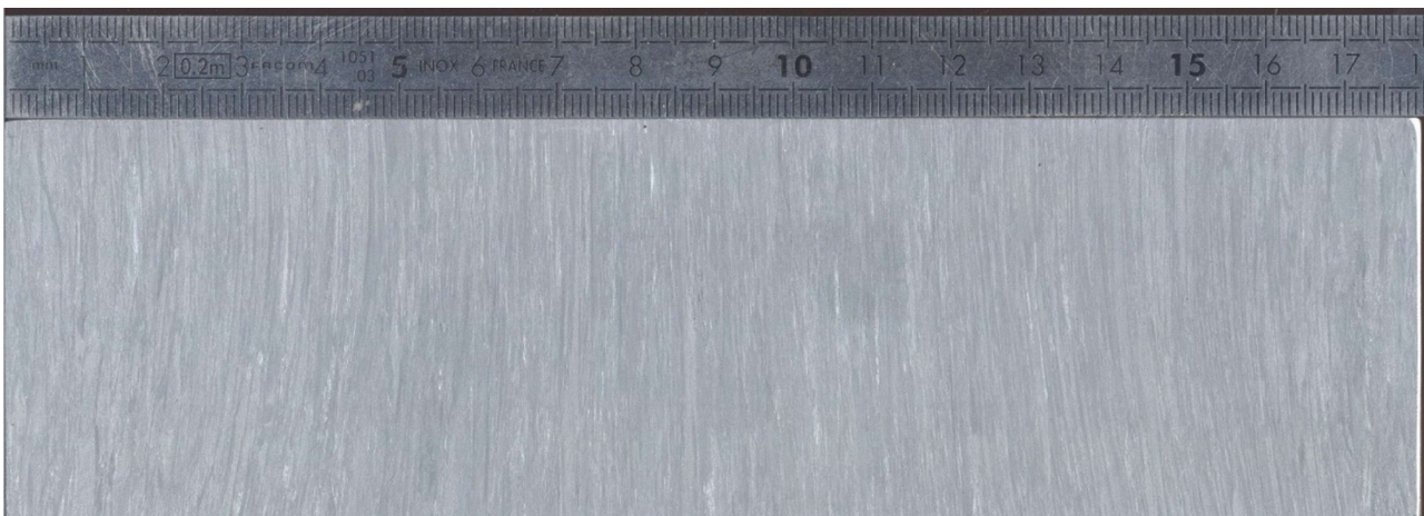
Figure 34 : Macrographie sens long de l'alliage TA6V ELI coulée 901650C.
