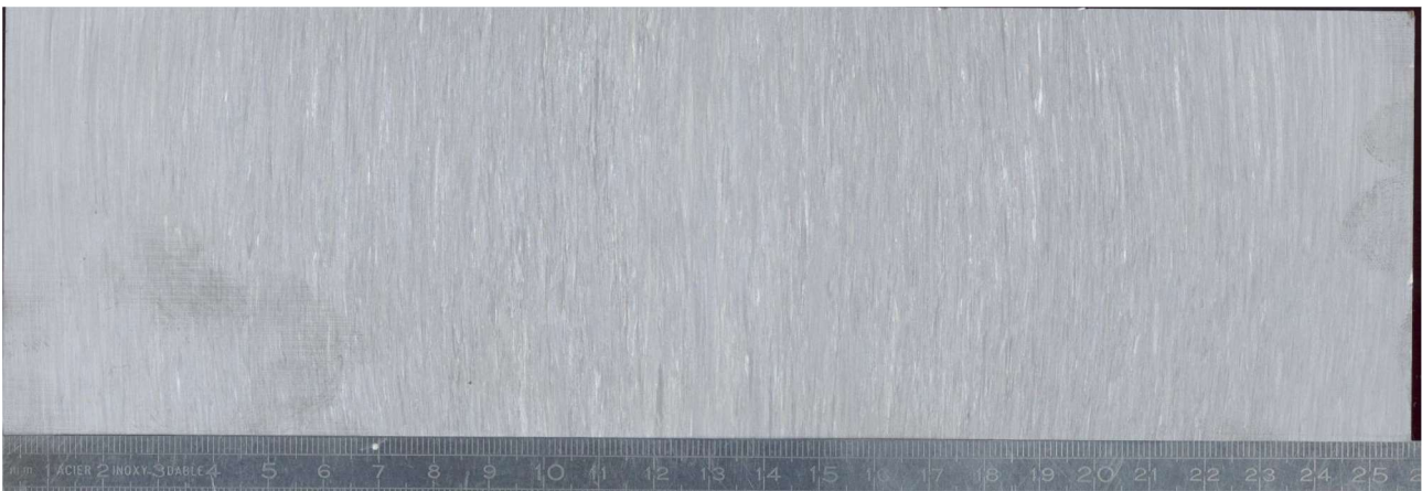
Figure 36 : Macrographie sens long de l'alliage Ti54M coulée 307553C.
