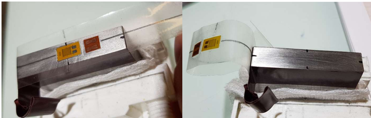
Figure 184 : mise en place du scotch de jauge.
