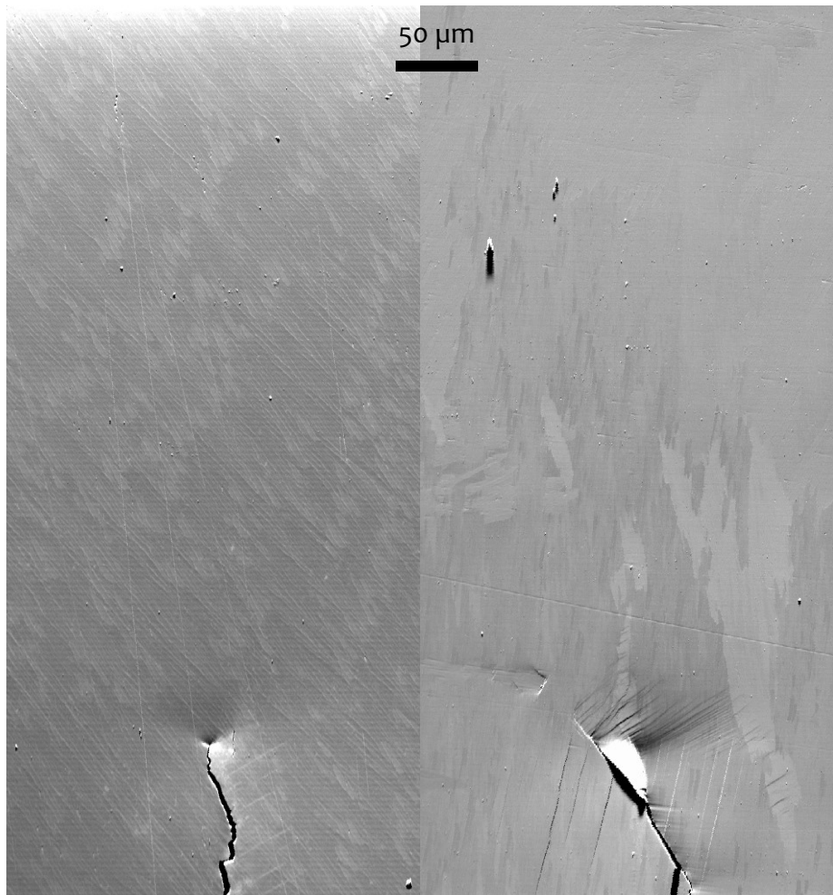
Figure 164 : Photo en électron rétrodiffusés lors de l'essai in-situ \Delta K 40 (gauche) et \Delta K 20 (droite), à K = 26\text{MPa}\sqrt{\text{m}} .
