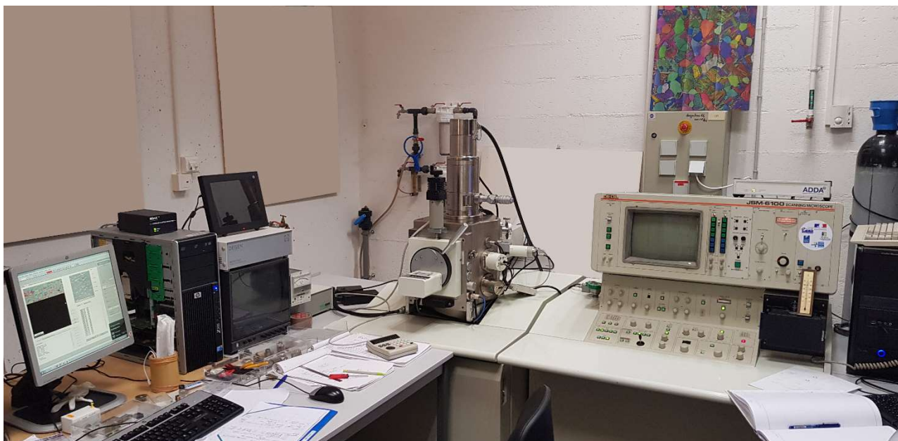
Figure 50 : MEB JEOL 6100 équipé d'un capteur EBSD.
