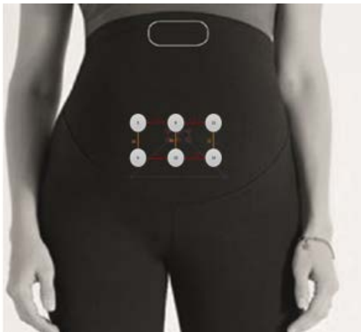
Figure 52 : Electrodes incorporées au vêtement. Dans le projet SAFE Pregnancy@home, l'objectif fixé est de recueillir et d'analyser les signaux EHG à l'aide de 8 électrodes (seules 6 sont représentées ici).
