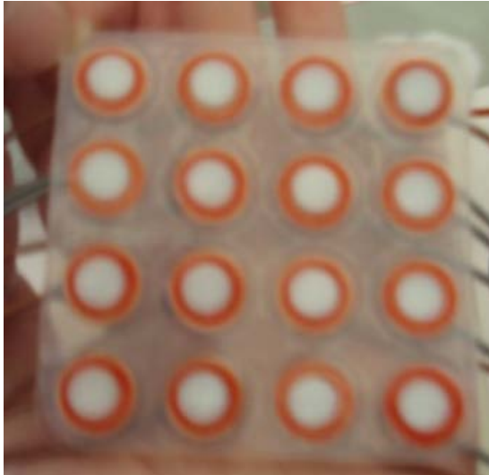
Figure 25 : Dispositif représentant une matrice en silicone liant 16 électrodes remplies de gel électrolytique
