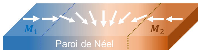
FIGURE 2.5 – Retournement d'aimantation dans un matériau magnétique à l'interface de deux domaines magnétiques. \mathbf{M}_1 et \mathbf{M}_2 sont les aimantations anti-parallèles des deux domaines séparés par une paroi de Néel.
