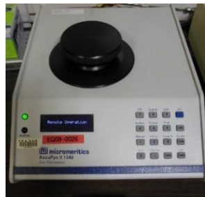
Figure II. 19 : Pycnomètre à hélium Accupyc 1330 du LCTS
