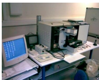
Figure II. 16 : Micro spectromètre Raman Labram HR du LCTS
