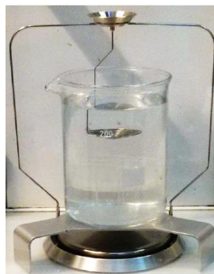
Figure II. 18 : Montage du LCTS pour les mesures par pesée hydrostatique
