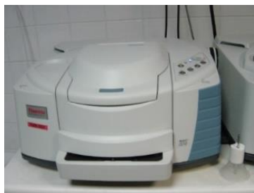
Figure II. 17 : Spectromètre FTIR Thermo Scientific Nicolet IS10 du LCTS
