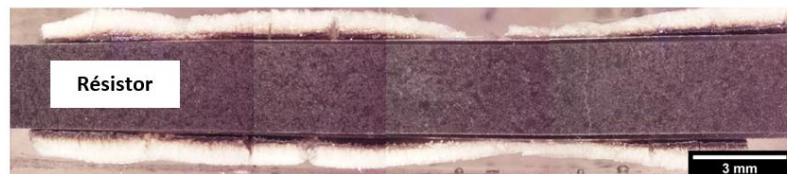
Figure III. 11 : Photographie à la loupe binoculaire de l'échantillon 4 sans préforme fibreuse et avec thermocouples
