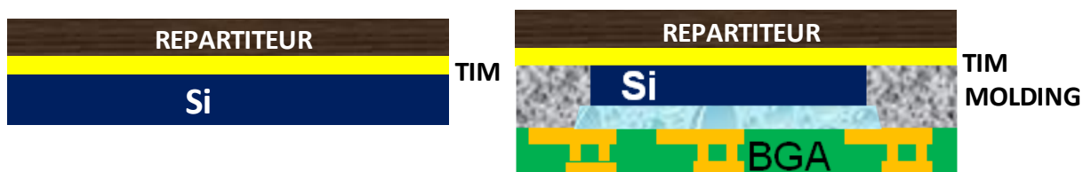
Fig. 76. Structure des échantillons. À gauche, structure tri-couche pour des évaluations rapides. À droite, répartiteur implémenté sur un boîtier flip-chip.
