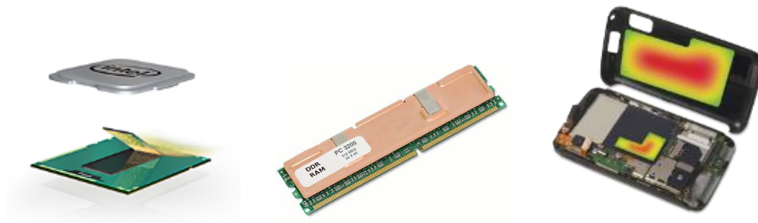
Fig. 23. Répartiteurs thermiques utilisés dans des différentes applications : Sur un microprocesseur (à gauche), une mémoire RAM (au centre) ou la coque d'un téléphone portable (à droite)
