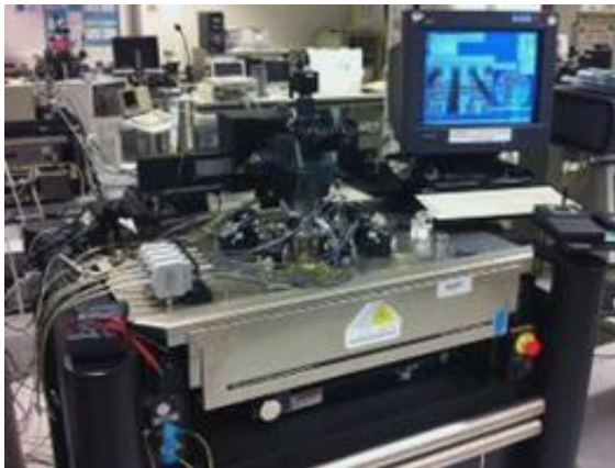
Fig. 48. Banc de test Cascade Microtech avec 6 pointes manuelles et une platine chauffante en acier inox
