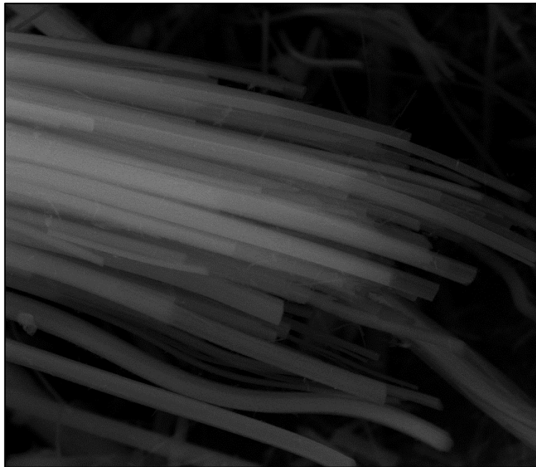
Nanotubes de silice analysés par microscopie électronique à balayage
