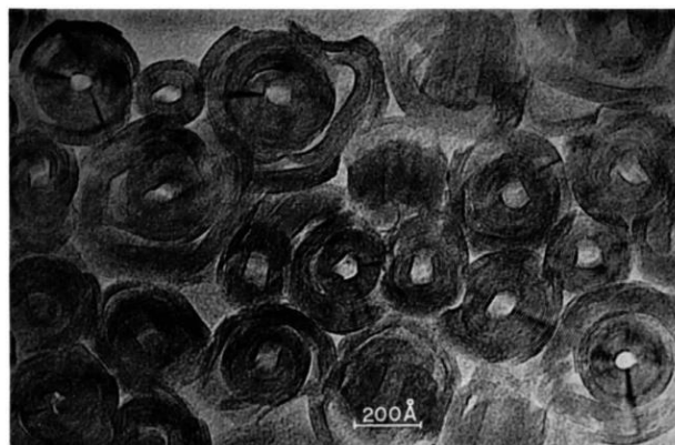
Figure I.4 : Image réalisée en microscopie électronique à haute résolution d'un échantillon de chrysotile de Tasmanie (Yada et al 1971) [10]
