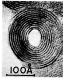
Figure I.5 : Image réalisée microscopie électronique à haute résolution d'un échantillon de chrysotile de Tasmanie (Yada et al 1971) [10]
