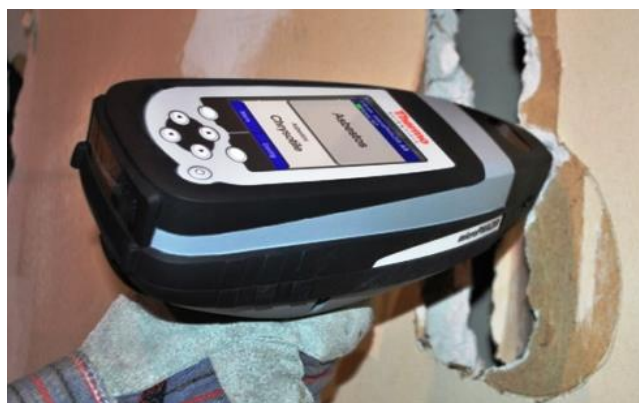
Figure I.11 : Image du PhazIR™ Amiante (Plychromix, USA), crédit photo Fondis Electronic
