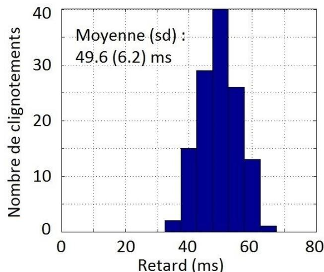
**Figure 29.** Histogramme des retards, obtenus grâce à la méthode de la photodiode, pour le logiciel développé dans le cadre du projet ANR RoBIK<sup>25</sup>.
