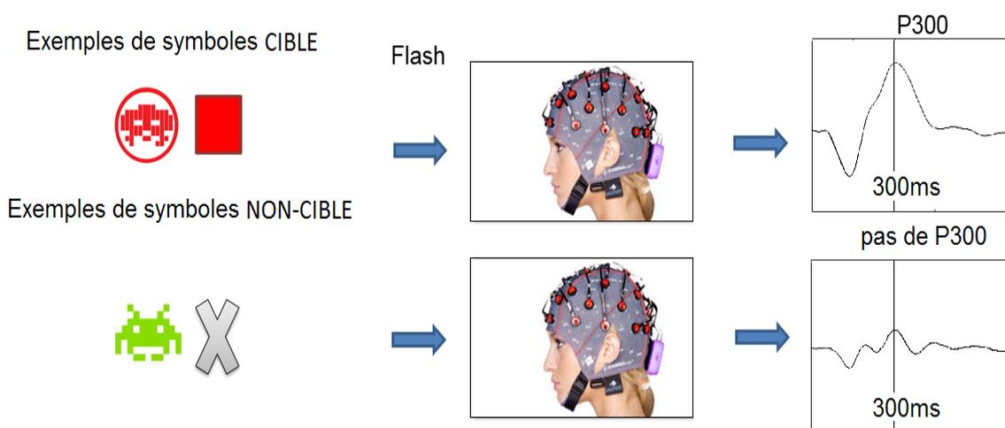
**Figure 6.** Principe de fonctionnement d'une BCI basée sur le P300. Le stimulus déviant, appelé CIBLE provoque une perturbation du signal EEG lorsqu'il est remarqué par l'utilisateur. Les figures sur la colonne de droite montrent la forme générale du signal CIBLE et NON-CIBLE moyenné, à une électrode, sur plusieurs essais.
