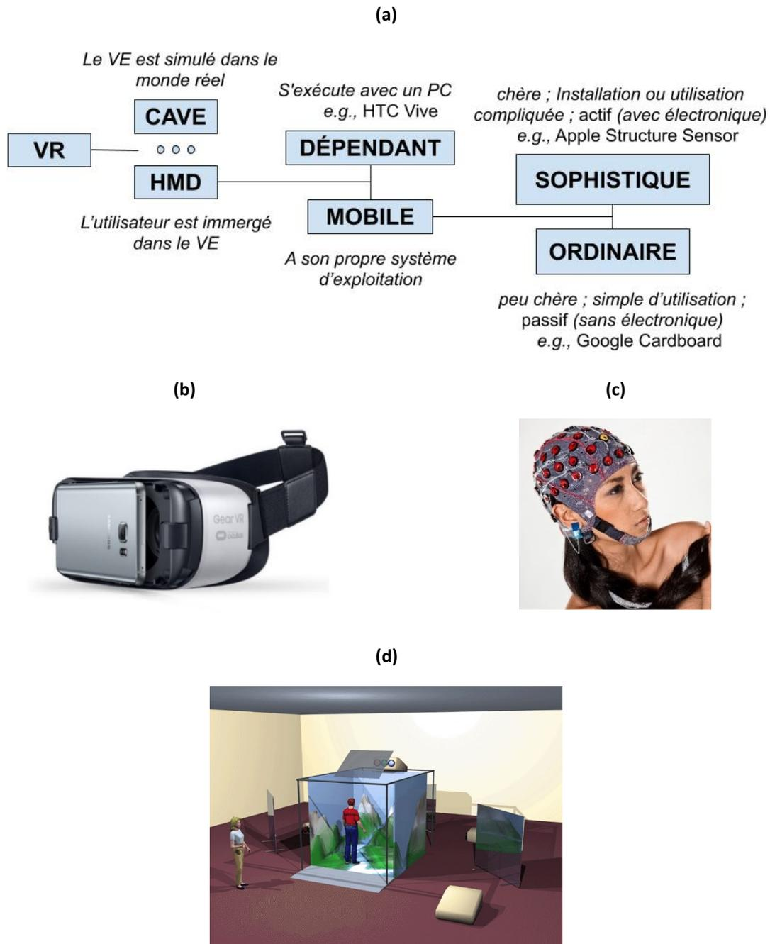
**Figure 1.** (a) Classification non exhaustive des matériels de VR (HMD : Head-Mounted Display). (b) Le SamsungGear est un appareil de réalité virtuelle qui immerge l'utilisateur dans un environnement virtuel au moyen d'un casque. (c) Casque EEG de la marque g.tec (Graz, Autriche). (d) La CAVE (Cave Automatic Virtual Environment) est un dispositif de réalité virtuelle qui reproduit l'environnement virtuel aux moyens de projecteurs dirigés sur 3 à 6 murs d'une pièce cubique.
