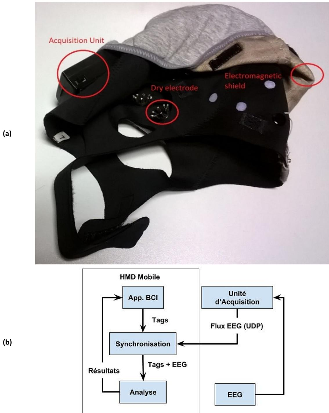
**Figure 31.** Prototype de casque EEG mobile ([eeg.io](http://eeg.io)) : (a) unité d'acquisition, électrode sèche et bouclier électromagnétiques (b) schéma idéal de fonctionnement d'une P300-BCI avec ce casque mobile.
