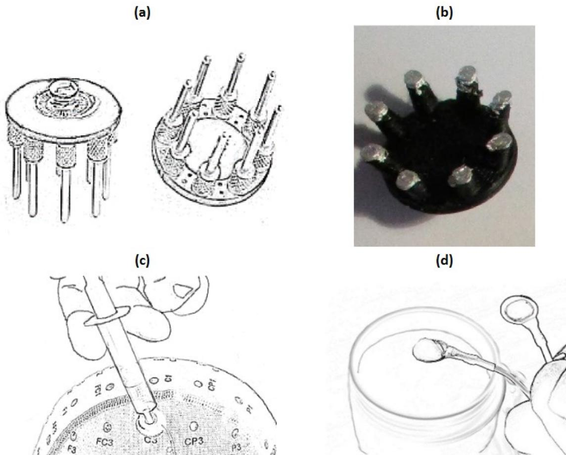
**Figure 9.** Electrodes sèches : (a) 'g.Sahara' (Guger Technologies, Graz, Autriche) et (b) 'Flex sensor' (Cognionics, San Diego, US) ; électrodes humides : (c) image montrant comment le gel est injecté dans une électrode 'g.LADYbird' (Guger Technologies, Graz, Autriche) et (d) 'Gold cup electrodes' (OpenBCI, New York, US), qui peuvent être fixées sur le crâne au moyen d'une pâte de fixation conductrice.
