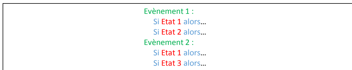
Figure 37. Fonctionnement d'une machine à état simple (3 états, 2 évènements).
