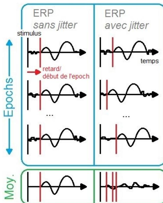
**Figure 26.** Influence du jitter sur la moyenne des ERP pour un grand nombre d’epochs. La moyenne des epochs synchronisées fait disparaître le bruit. La moyenne des epochs désynchronisées se confond avec le bruit et tend vers zéro.
