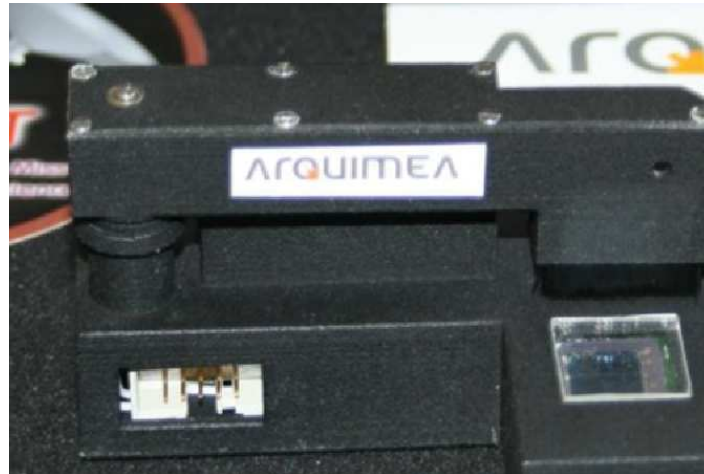
FIGURE 1.21 – Actionneur rotatif à base d'AMF utilisé en aérospatial [29].
