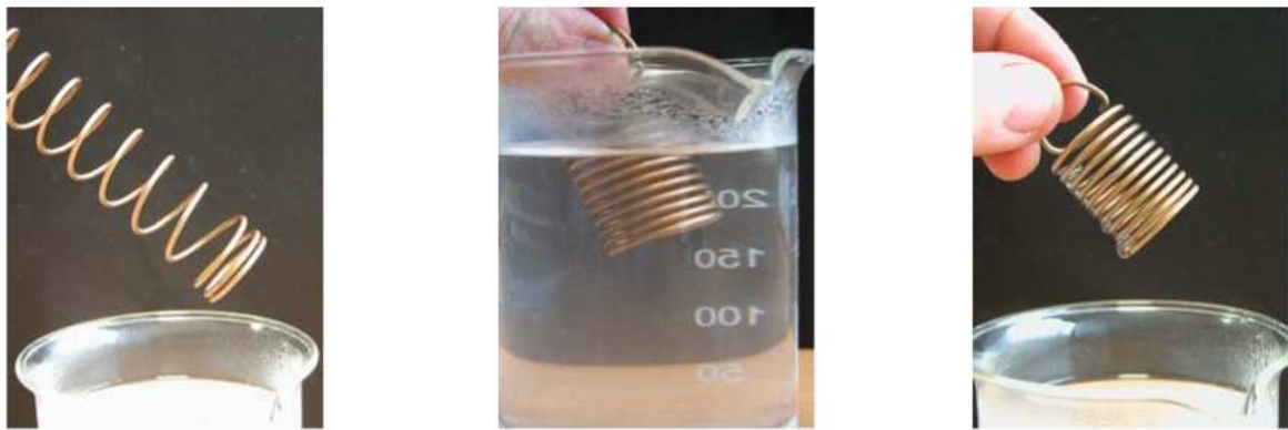
FIGURE 1.14 – Ressort en NiTi plongé dans l'eau chaude [Nimesis, Mécleuves, France]
