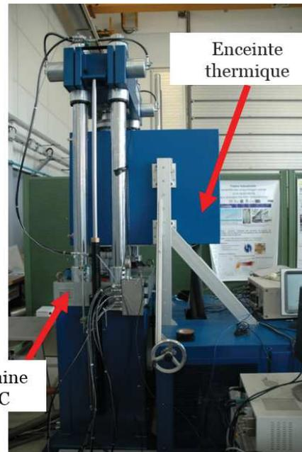
(b) Machine Traction-Torsion-Compression et enceinte thermique.
