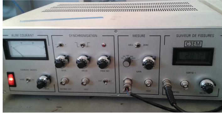
FIGURE 2.27 – Suiveur de fissure.
