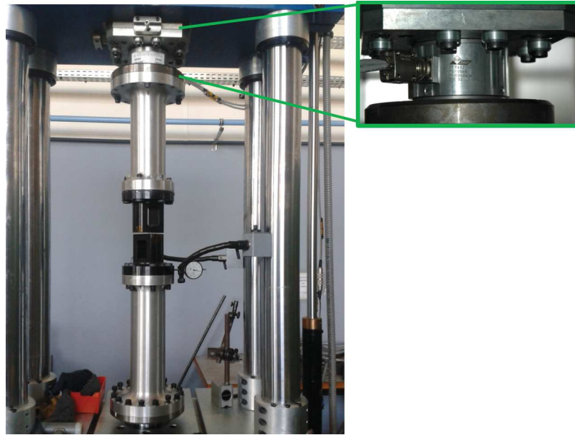
FIGURE 2.21 – Machine TTC équipée des rallonges et des mors.
