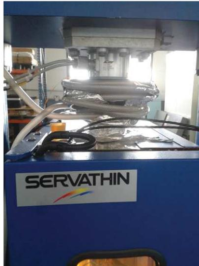
FIGURE 2.23 – Système de chauffage de la plaque d’interface.
