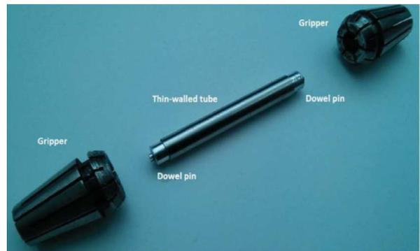
(b) Configuration d’essai d’un AMF de NiTi.
