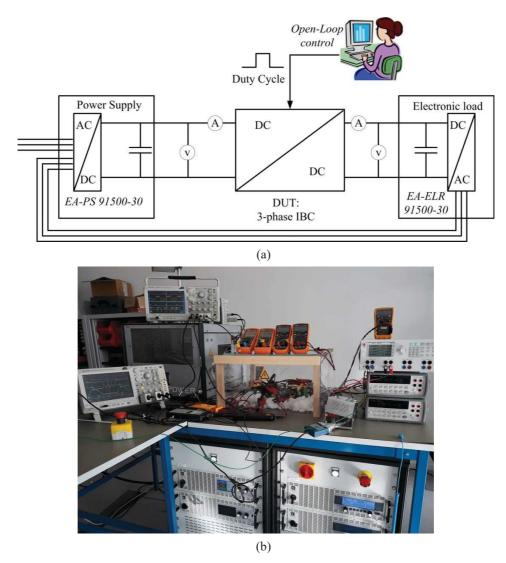
Figure 21: Banc de test électrique: (a) schéma, (b) photo
