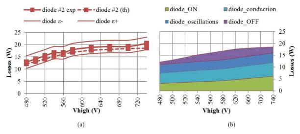
Figure 23: pertes dans la diode du bras #2 : (a) comparaison entre les mesures expérimentales (les erreurs de mesure étant représentés par les petites lignes) et le modèle analytique, (b) pertes de la diode #2 dans chaque de phase de la commutation
