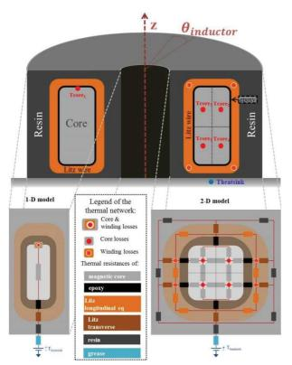
Figure 18: Modèles thermiques 1D ou 2D de l'inductance de bras du hacheur série entrelacé
