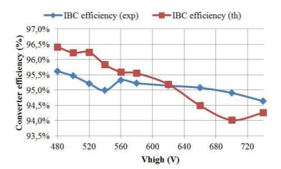
Figure 25: Comparaison du rendement global théorique avec le rendement global mesuré en fonction de la tension d'entrée du convertisseur
