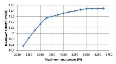
Figure 27: Evolution de la densité de puissance du convertisseur en fonction de sa puissance nominale
