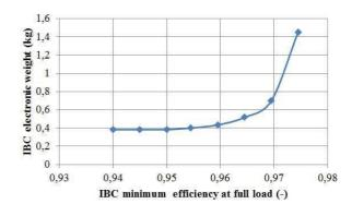
Figure 29: Front de Pareto entre le rendement et la masse du convertisseur
