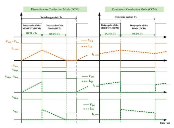
Figure 7: Schéma du Buck entrelacé et ses formes d'ondes idéales associées
