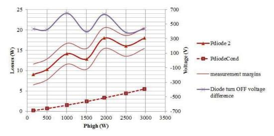
Figure 16: Diode Schottky SiC dans un IBC à 3 bras (a) formes d'onde théoriques à Pin = 2,5 kW, Vin = 700 V et Vout = 200 V, (b) mesure des pertes (Pdiode2) avec ses marges d'erreur, ses pertes théoriques par conduction et la différence de tension de la diode entre la phase oscillatoire et la phase de conduction du MOSFET
