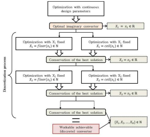
Figure 30: Processus de discrétisation heuristique avec  $X_n$  la  $n^{\hat{e}me}$  variable discrète, et la function objectif plus sensible à la variable  $X_1$  que  $X_2$ , etc.
