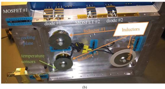
Figure 20: Photos du prototype, (a) vue du dessus, (b) vue du dessous
