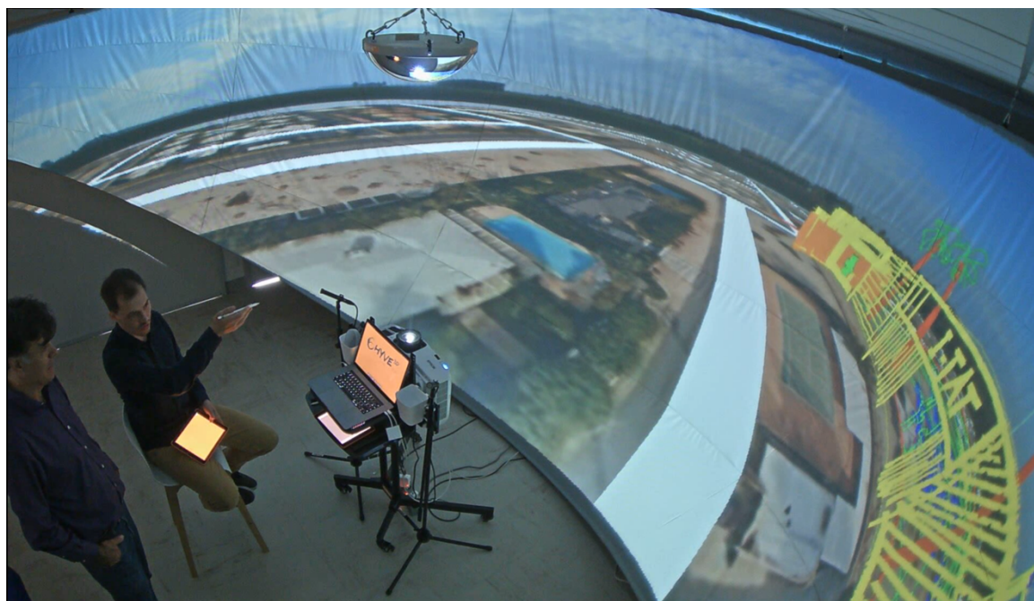
Figure 87 Exemple de session Hyve-3D. Le Hyve-3D se compose d'un écran immersif courbe où le projet de l'étudiant est projeté à l'échelle 1, et d'une interface de dessin et de navigation appelée Curseur 3D (Ipad).
