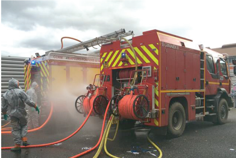
Figure 14. Couloirs d'eau à base d'échelles et des fourgons (prise en charge de 500 personnes valides/heure)
