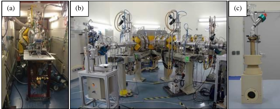
Figure IV-1 : Ligne des cyclotrons du CEMHTI (a) et d'ARRONAX (b), cellule de radiolyse en PEEK (c).
