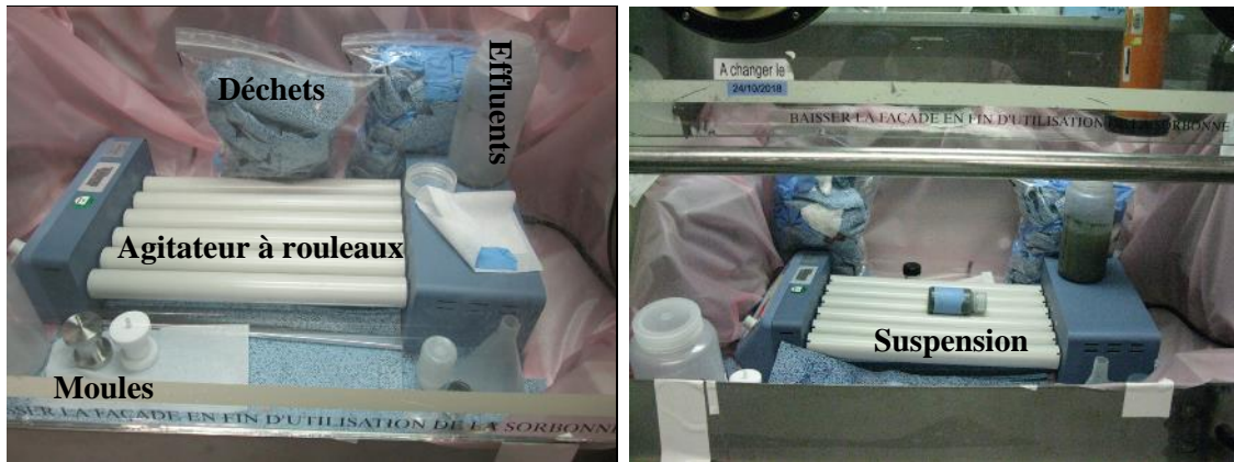
Figure IV-23 : Zone de travail des essais de coulage-gélification sur la poudre (U,Ce)O_2 en sorbonne (L18 - Atalante).
