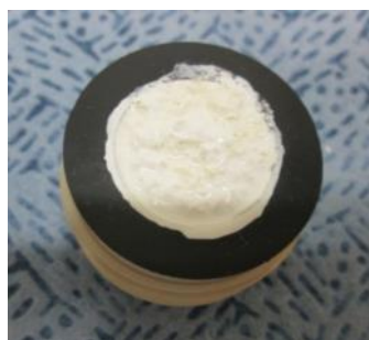
Figure IV-6 : Irradiation d'une suspension de \text{CeO}_2 « Opaline » (30% en volume) avec F1 (20%mass) sans APS-TEMED pendant 10 min (1636 J/(L.min)).
