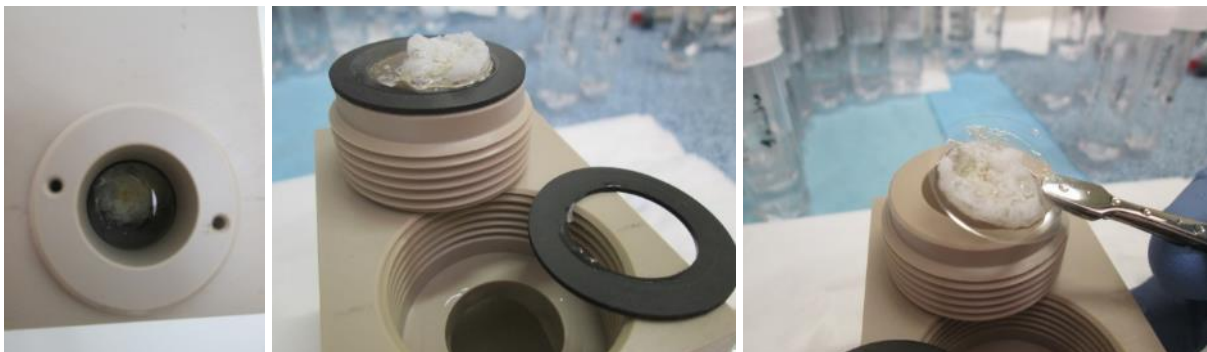
Figure IV-4 : Irradiation d'une solution F1 (20%mass) sans poudre et sans APS-TEMED pendant 30 min ( 1636 \text{ J}/(\text{L}\cdot\text{min}) ).
