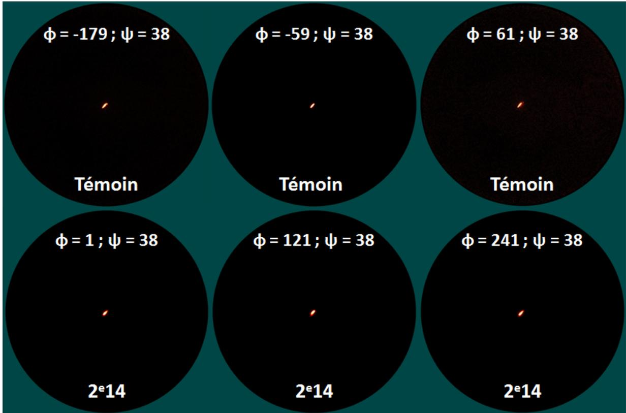
**Figure 4.1.12 :** Clichés pour l'étude de la texture de la réflexion  $(10\bar{1}4)$  pour l'échantillon témoin et l'échantillon irradié à  $2 \times 10^{14}$  ions/cm<sup>2</sup>. La valeur du paramètre  $\psi$  est fixée alors que celle du paramètre  $\phi$  varie. Les paramètres  $2\theta$  et  $\omega$  sont fixés sur la position de la réflexion.
