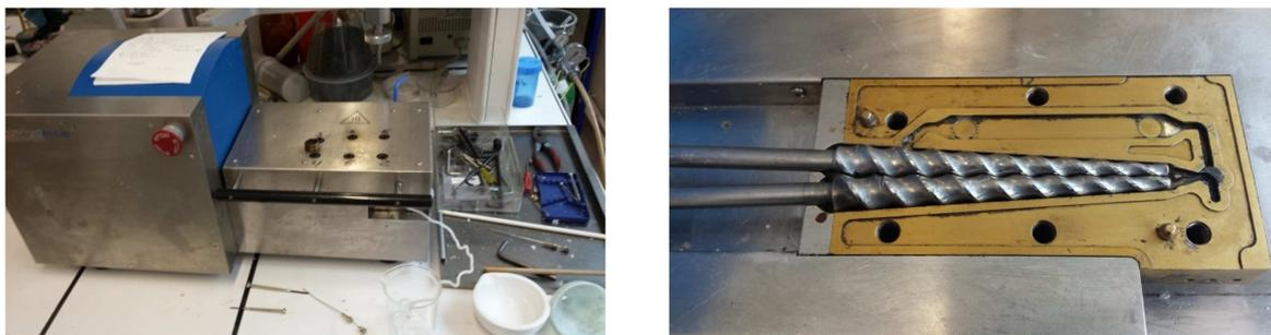
**Figure 4 : Thermo Haake MiniLab système bis-vis conique corotative interpénétrée (situé au laboratoire de l'URCA)**
