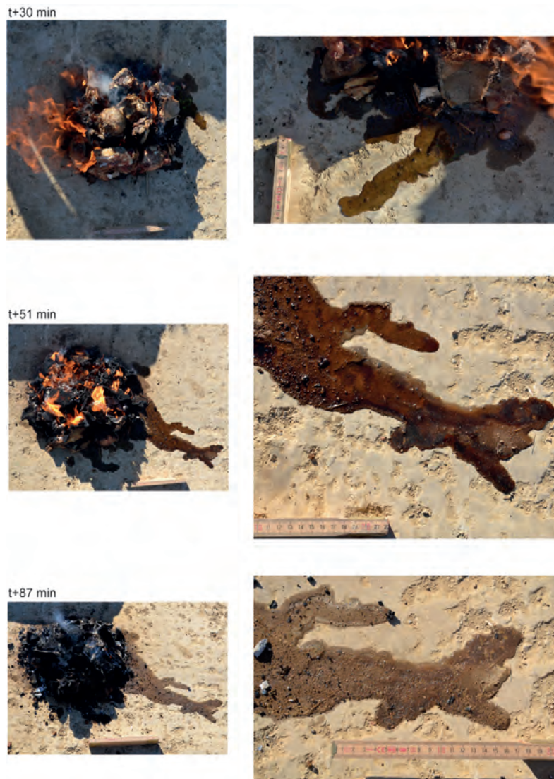
Figure IV.32: Fonctionnement du foyer 2012H, écoulement de graisse
