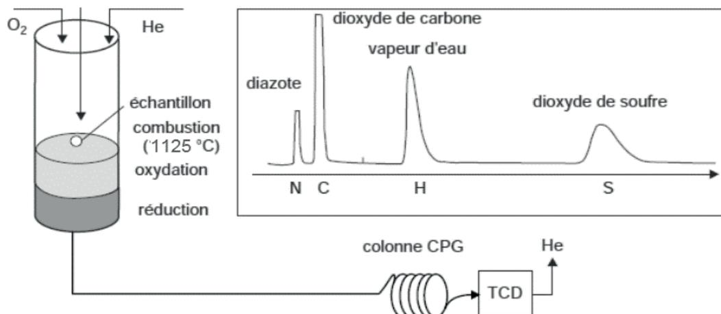
**Figure III.30:** Principes généraux de fonctionnement de l'analyseur élémentaire (d'après Rouessac et Rouessac, 2004).
