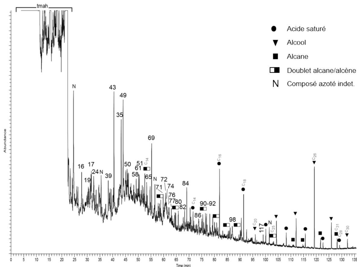
**Figure VI.94:** Pyrochromatogramme de l'échantillon D28-2 (les numéros renvoient au Tabl. Ann. G.1 ; p, dérivés de plastique et polluants, c, colonne, tmah : dérivés du TMAH ; C<sub>x</sub> indique le nombre de carbones sur la chaîne linéaire pour les composés les plus courts, les plus longs et les principaux contributeurs de chaque série).
