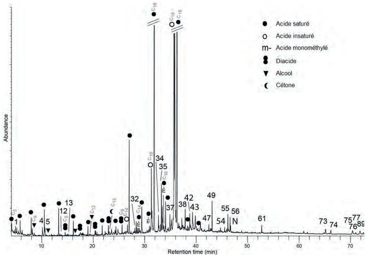
**Figure IV.76:** TIC de l' chantillon 2014 IIId (les num ros renvoient au Tabl. Ann. F.1; p, d riv s de plastique et polluants, c, colonne;  $C_x$  indique le nombre de carbones sur la cha ne lin aire pour les compos s les plus courts, les plus longs et les principaux contributeurs de chaque s rie).
