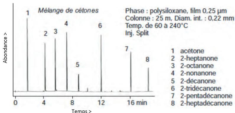
**Figure III.32:** Exemple de chromatogramme d'un mélange de cétones, identifiés à partir de leurs temps de rétention (d'après Rouessac et Rouessac, 2004).
