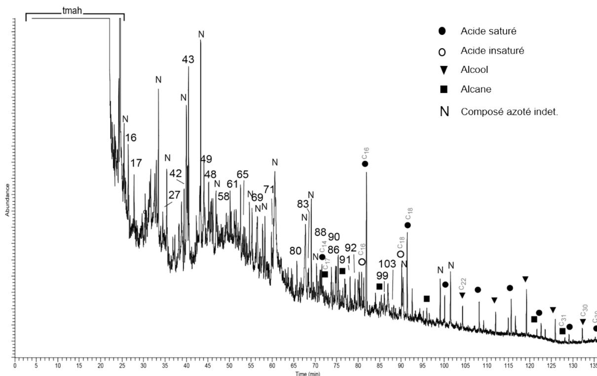
**Figure VI.92:** Pyrochromatogramme de l'échantillon Zone B (les numéros renvoient au Tabl. Ann. G.1 ; p, dérivés de plastique et polluants, c, colonne, tmah : dérivés du TMAH ;  $C_x$  indique le nombre de carbones sur la chaîne linéaire pour les composés les plus courts, les plus longs et les principaux contributeurs de chaque série).
