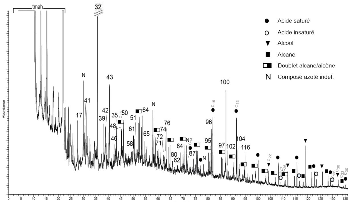
**Figure VI.95:** Pyrochromatogramme de l'échantillon EF22-6 (les numéros renvoient au Tabl. Ann. G.1 ; p, dérivés de plastique et polluants, c, colonne, tmah : dérivés du TMAH ; C<sub>x</sub> indique le nombre de carbones sur la chaîne linéaire pour les composés les plus courts, les plus longs et les principaux contributeurs de chaque série).
