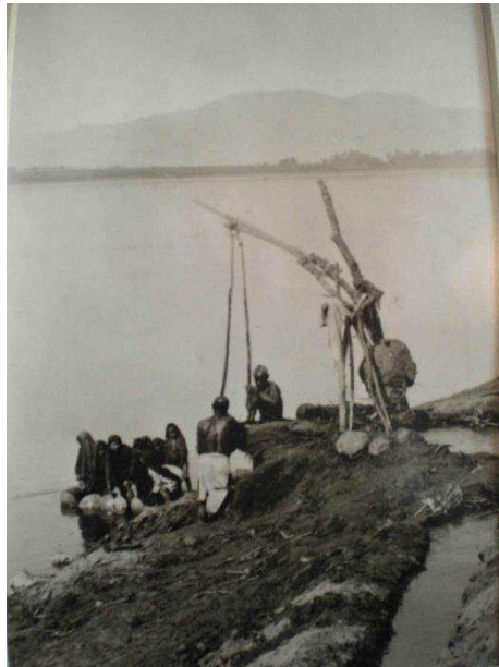
Fig.114 - Exemple d'un shādūf sur le bord du Nil, actionné par deux hommes, photographie de Lehnert et Landrock en 1924.
