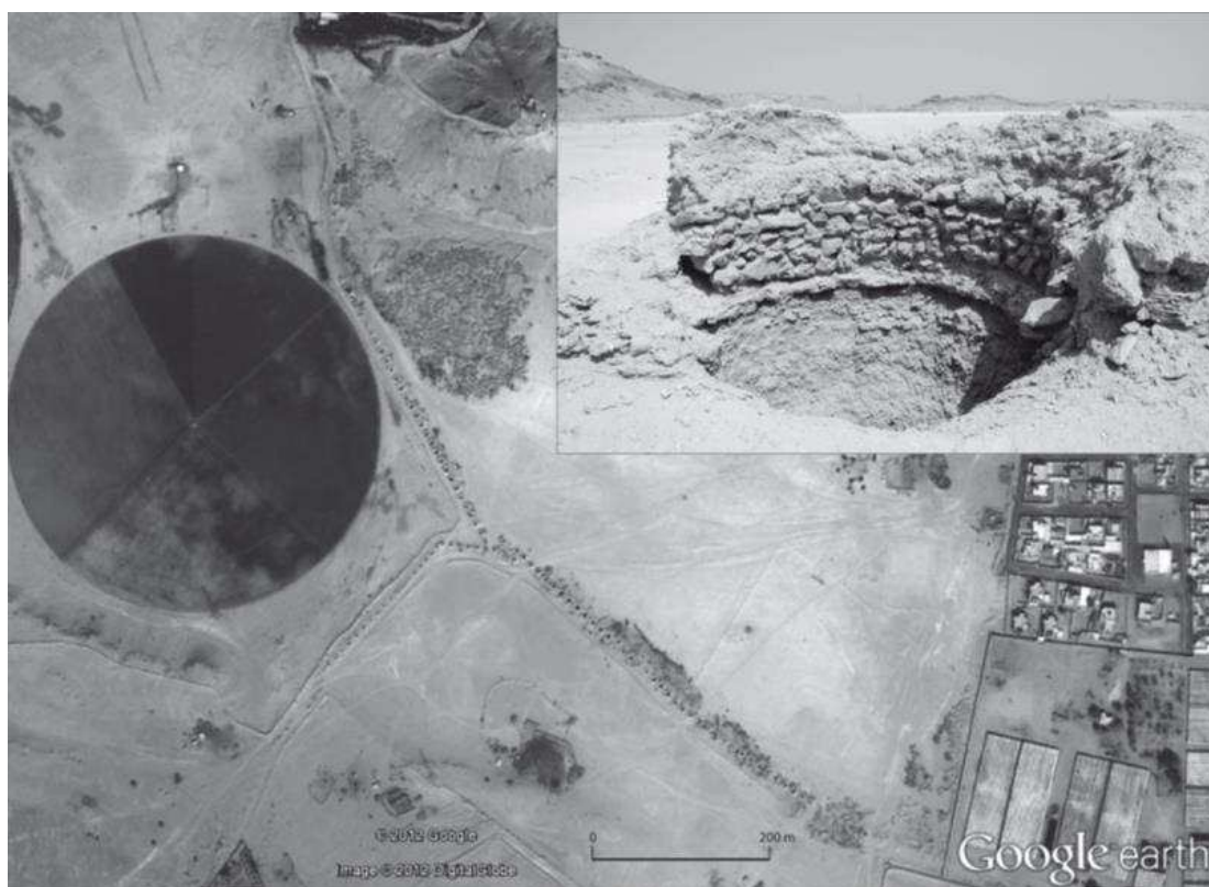
Fig.126- Vue aérienne d'une galerie drainante dans l'oasis d'al-Kharj et détail d'un puits d'aération, dans Schiettecatte et al. 2013 : 29.
