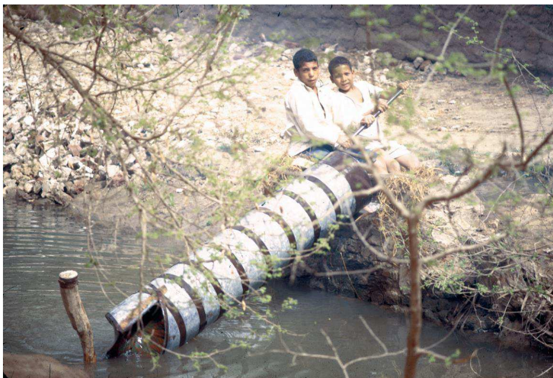
Fig.122 - Vis d'Archimède actionnée par deux enfants dans les années 1970 au Fayoum, dans Hairy 2011b : 261.
