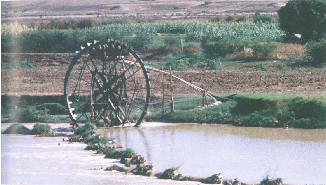
Fig.110 - Photographie d'une roue élévatrice sur le Wādī Sabū. Une digue disposée en oblique dans le lit de la rivière permet de détourner une partie de l'écoulement vers la structure, dans Bazzana et Montmessin 2004 : 341.
