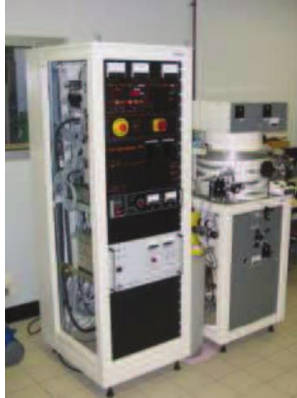
Figure 2-4 : Appareil de pulvérisation cathodique magnétron ALCATEL CIT de type A450.
