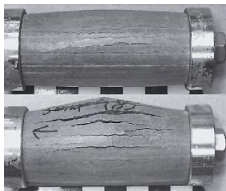
Figure 1-14. Exemples de rupture des cylindres atteints de RSE par effet de voilement des parois (Müllauer et al. , 2013).
