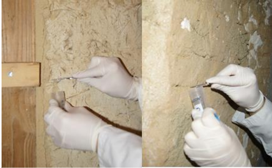
Figure 3.3 : Méthode de prélèvement des sites Bb (gauche) et D (droite) par grattage au scalpel.
