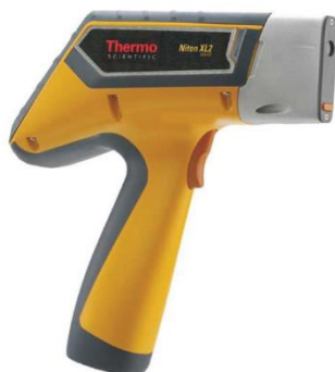
Figure 132 : Analyseur à fluorescence X NITON XL2 GOLDD, de ThermoFisher SCIENTIFIC
