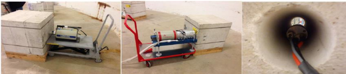
Figure 34 : Photographies du détecteur coaxial (à gauche), du détecteur BEGe (au centre) et du détecteur LaBr 3 (à droite) lors des mesures des blocs étalons à Bessines
