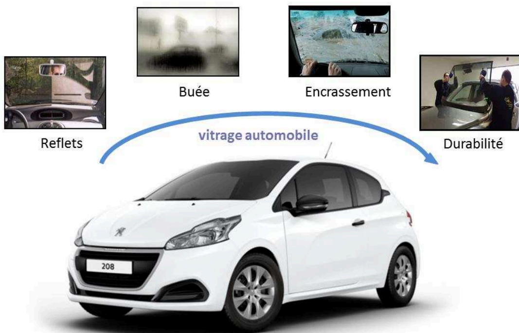
Figure A : Phénomènes responsables de la dégradation des propriétés des surfaces vitrées d'un véhicule diminuant ainsi la sécurité et le confort de l'utilisateur.
