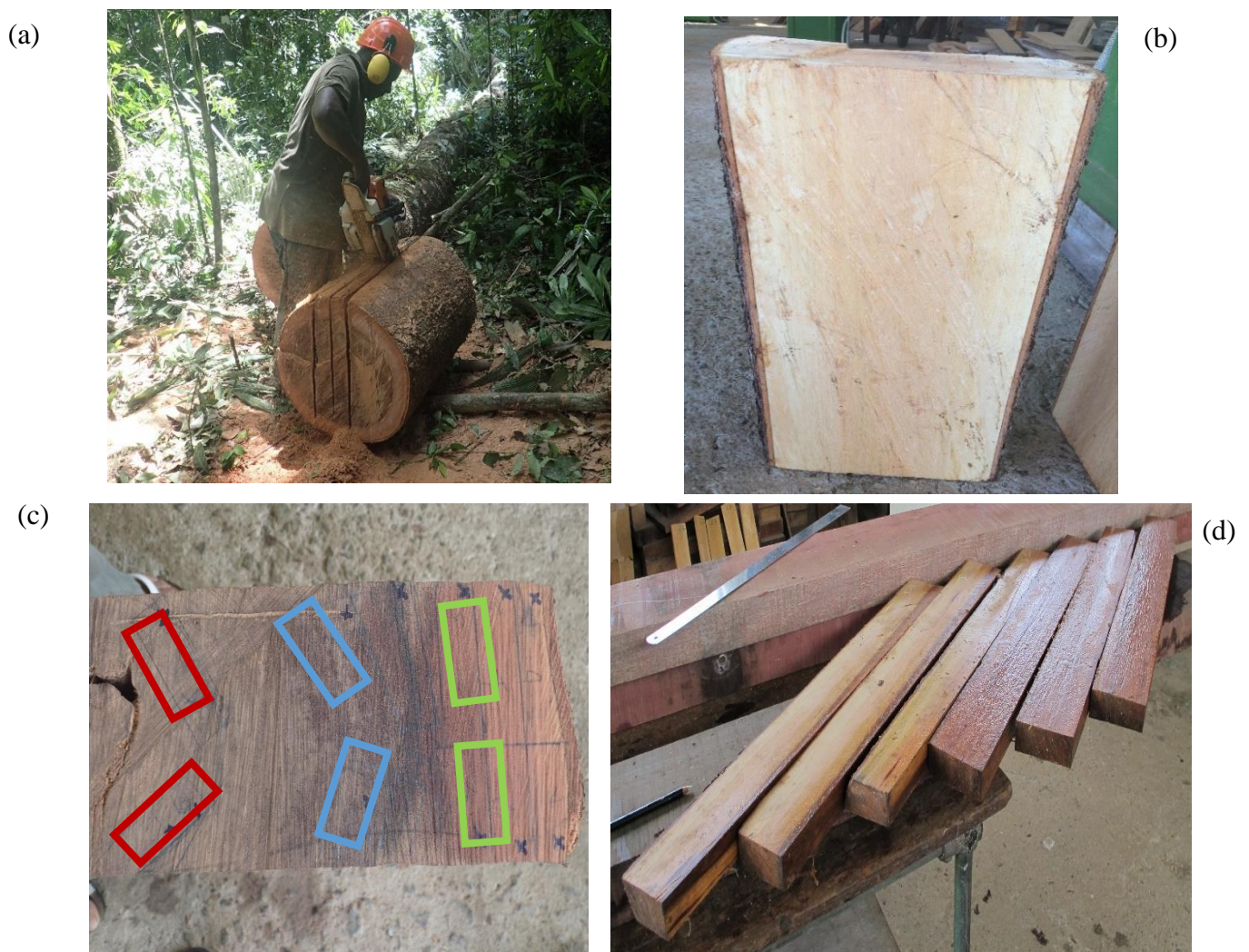
Figure 24: Préparation des échantillons avec (a): découpage du billon en forêt, (b) : le plateau , (c) : la délimitation des planches jumelles par position radiale et (d) : la planche de bois destinée au séchage
