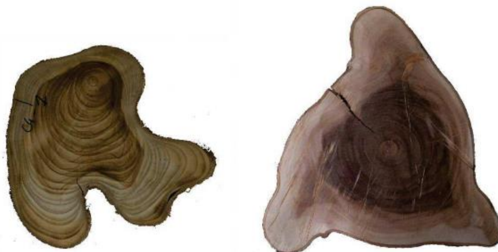
Figure 3: Photographies des sections transversales du bois de Bagassa guianensis (à gauche ; Photo de Julie Bossu) et de l'Angélique (à droite) (Lehnebach 2015)
