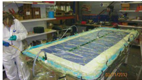
(d) Checking for air tightness under vacuum
