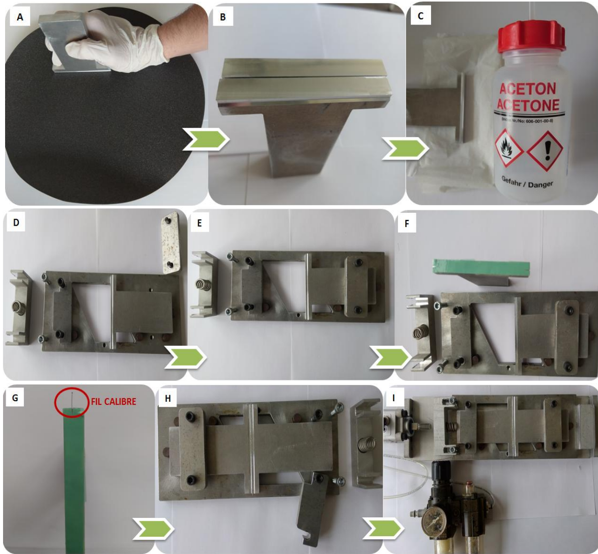
Figure II. 10. Principales étapes de collage des éprouvettes Scarf modifiées.
