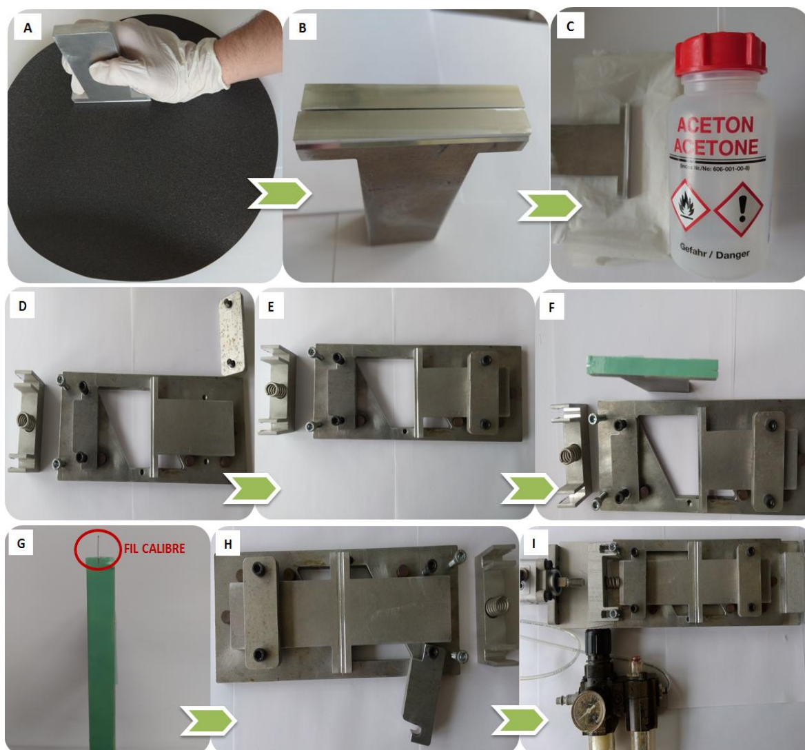
Figure II. 10. Principales étapes de collage des éprouvettes Scarf modifié.
