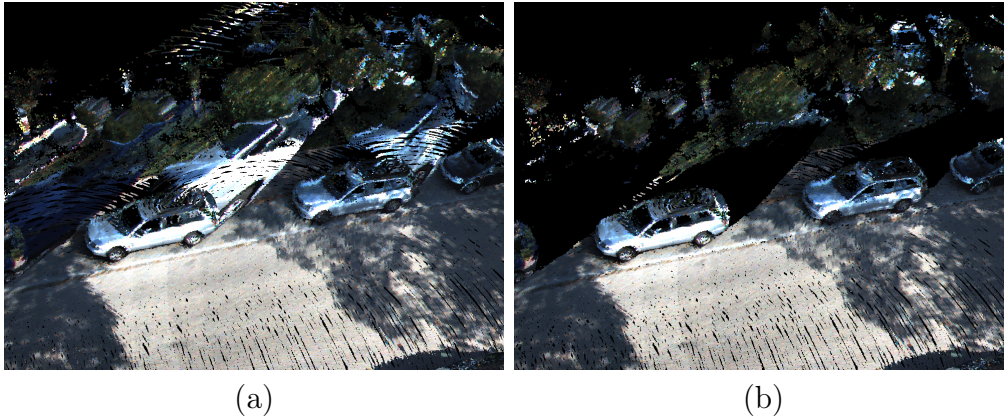
Figure 3: Colorisation d'un nuage de points sans estimation de visibilité (a) et avec estimation de visibilité (b).
