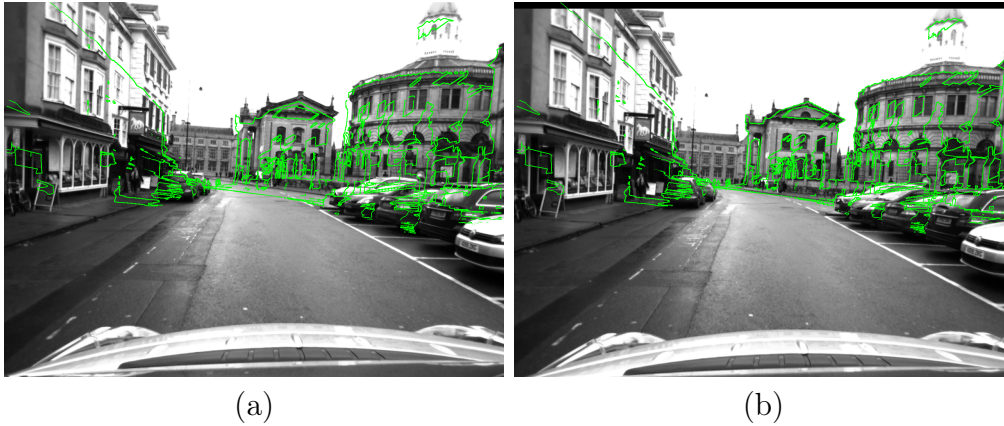
Figure 5: Exemple d’alignement optique / LiDAR. (a) montre le décalage initial, (b) montre le résultat de l’alignement. Les tracés verts mettent en avant les contour du nuage de points projeté que l’on cherche à aligner.
