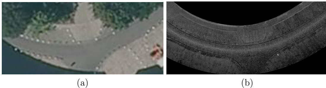
Figure 1: Comparaison entre une (a) orthophotographie aérienne classique de résolution 0.5\text{m}^2/\text{pixel} et (b) notre résultat terrestre de résolution 1\text{cm}^2/\text{pixel} .
