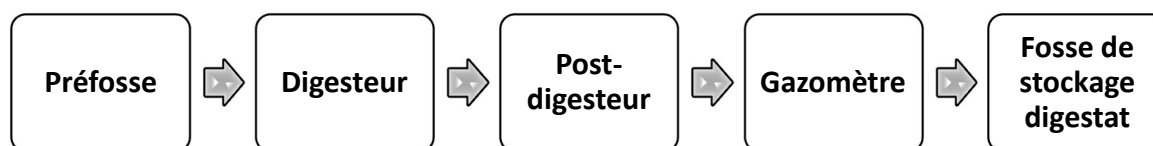
Figure 7: Différents composants d'une installation de méthanisation
