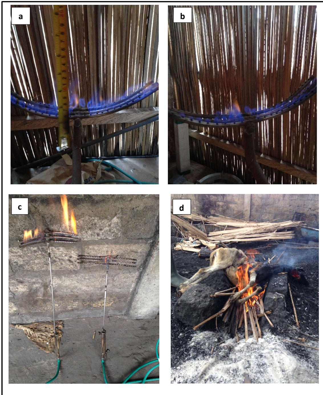
**Figure 52: Illustrations des flammes induites: biodigester direct (a), pose de 200 kg sur le ballon (b), utilisation d'un suppresseur (c) et bois de feu (d)**
