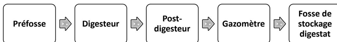
**Figure 7: Différents composants d'une installation de méthanisation**
