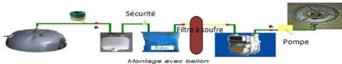
Figure 17 : Montage de récupération et de transfert du biogaz vers la source de consommation
