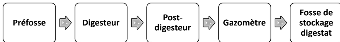
Figure 7: Différents composants d'une installation de méthanisation
