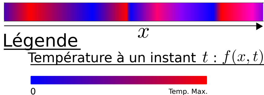
FIGURE 4.4 – Exemple de la diffusion d'un matériau unidimensionnel à un instant donné t , en fonction de sa coordonnée x
