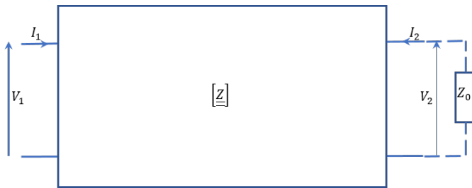
FIGURE H.3 : Réseau à deux ports.
