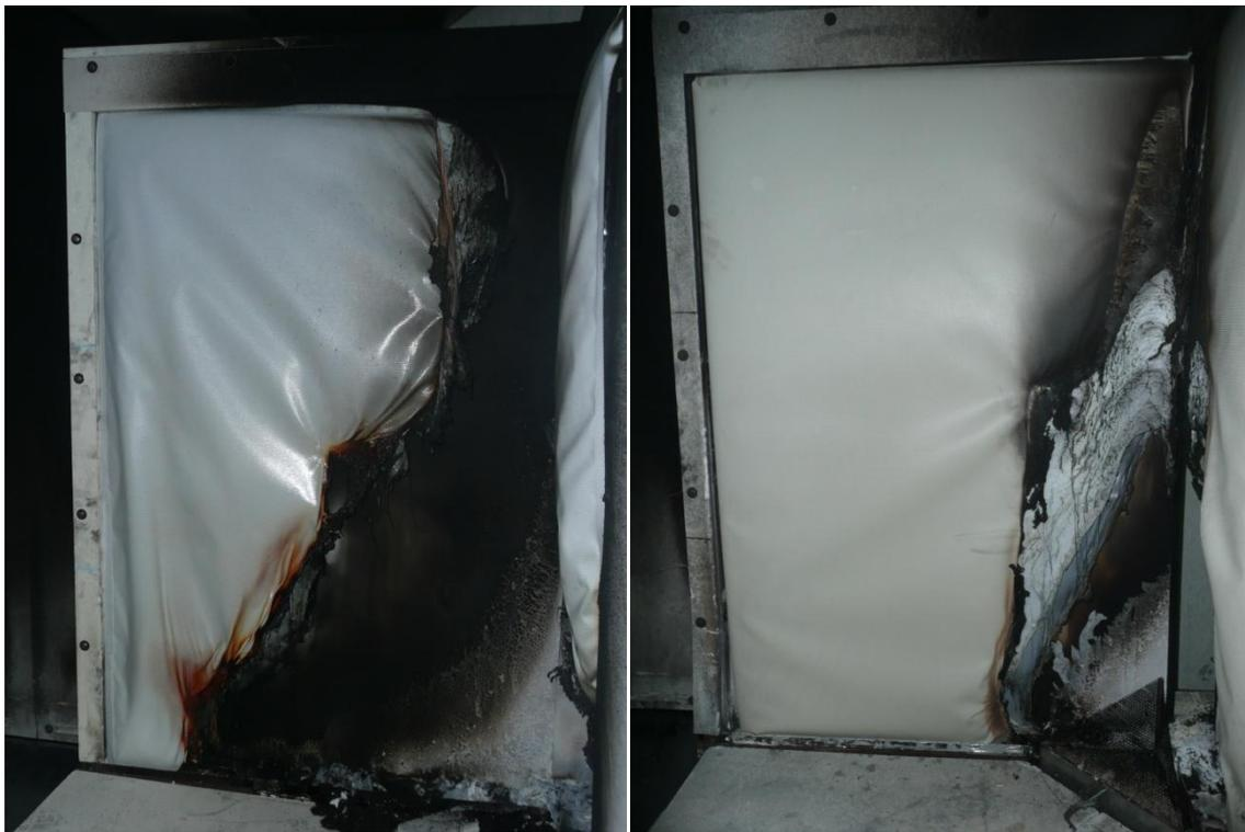
*Figure 90 : Photos des éprouvettes après l'essai SBI : à gauche la configuration 1, à droite la configuration 2.*
