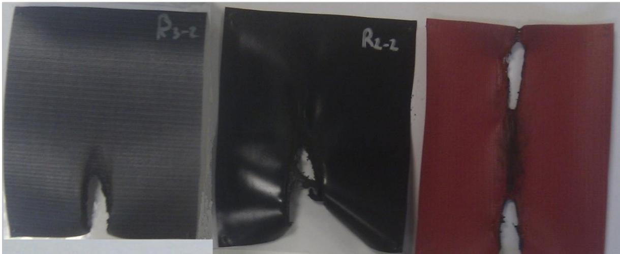
*Figure 87 : Photo des échantillons après essai d'orientation au feu sur les toiles avec attaque sur la tranche. De gauche à droite : toile 11, toile 3 et toile 1.*
