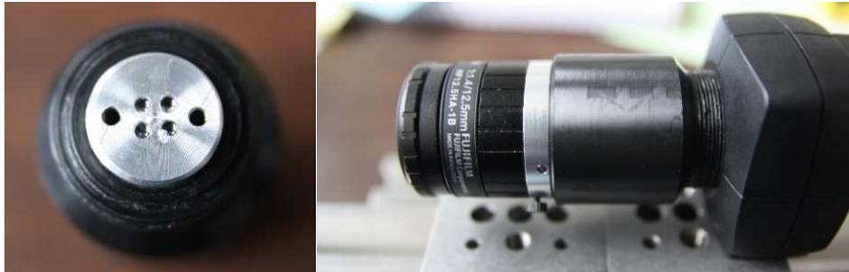
Figure 2.10 Premier prototype de système multi-vues plénoptique. A gauche, vue du dessus de la bague comprenant les mini-lentilles. A droite, vue complète du dispositif.
