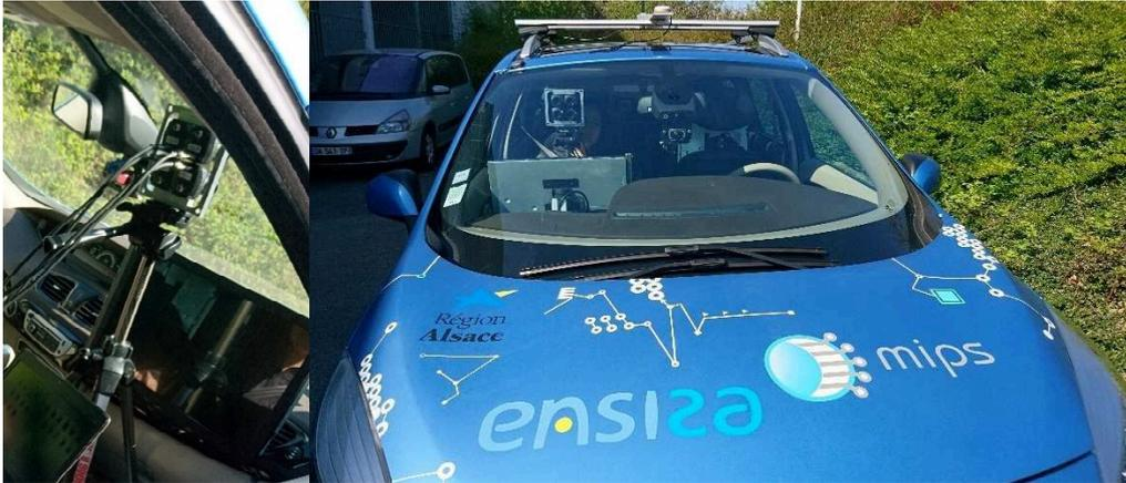
Figure 4.27 Prototype multi-caméras, présentés dans le Chapitre 2. A gauche : système multi-caméras positionné dans le véhicule ARTEMIPS, véhicule expérimental du laboratoire. A droite : vue du dispositif depuis l'avant du véhicule ARTEMIPS.
