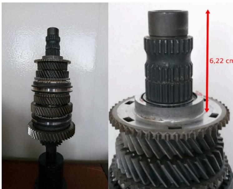
Figure 4.22 Boîte de vitesse. A gauche : une vue générale de l'objet. A droite : un zoom sur la hauteur à mesurer.
