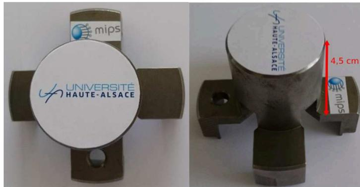
Figure 4.5 Pièce étalon utilisée afin de démontrer l'intérêt de l'utilisation d'un critère pour la mesure de flou dans les images refocalisées et calibrées en profondeur.
