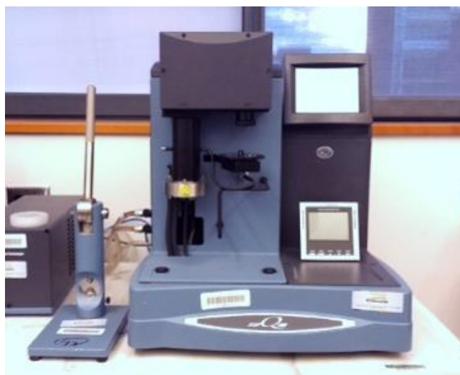
Figure 1.24 Thermogravimetric analysis (TGA) instrument (Laboratoire Procédés et Ingénierie en Mécanique et Matériaux, PIMM, ENSAM, Conservatoire National des Arts et Métiers, CNAM, Paris).
