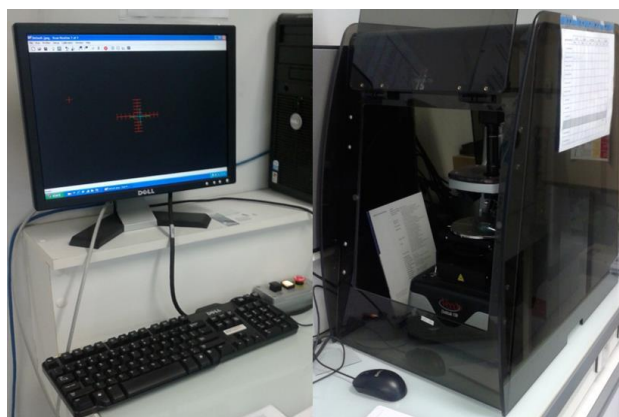
Figure 1.27 Surface profiler (Laboratoire de Physicochimie des Polymères et Interfaces, LPPI, Cergy-Pontoise University).
