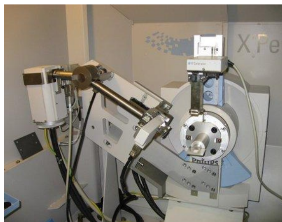
Figure 1.25 PANalytical X'pert pro MPD with X'celerator acquisition system (Institut de Chimie Moléculaire et des Matériaux d'Orsay, ICMMO)
