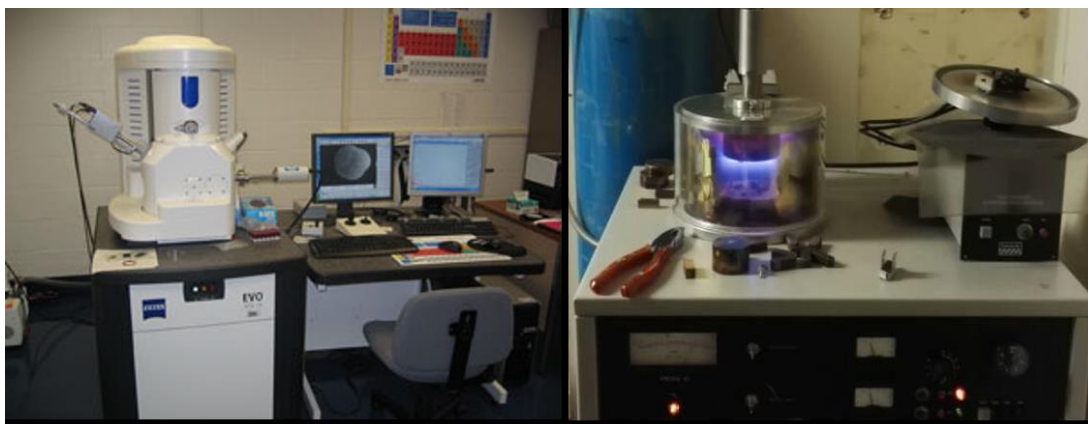
Figure 1.23 EVO MA10 SEM (left) and SC-6 Pelco Sputter Coater (Laboratoire Procédés et Ingénierie en Mécanique et Matériaux, PIMM, Conservatoire National des Arts et Métiers, CNAM, Paris).
