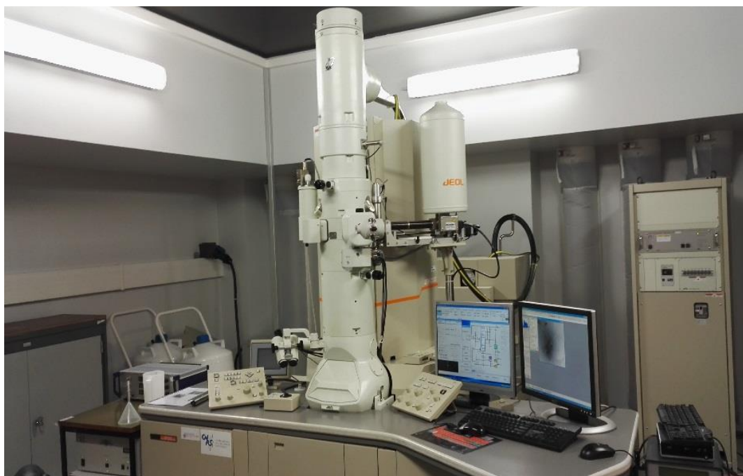
Figure 1.19 JEOL 2100 Cryo-TEM microscope (Institut de Minéralogie et de Physique des Milieux Condensés, IMPMC, Pierre and Marie Curie University).
