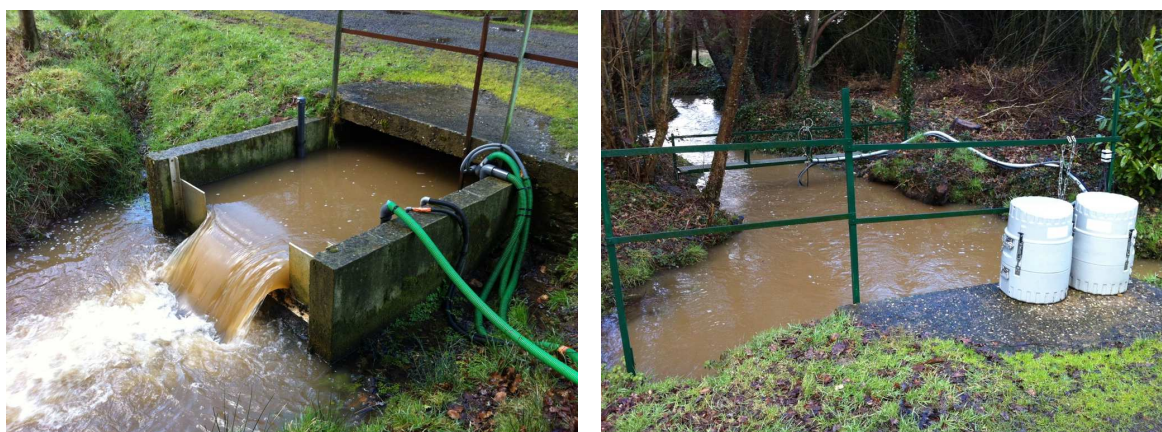
Figure 2-4 : gauche - seuil à l'exutoire du bassin versant ; droite - préleveurs automatiques situés quelques mètres en amont du seuil
