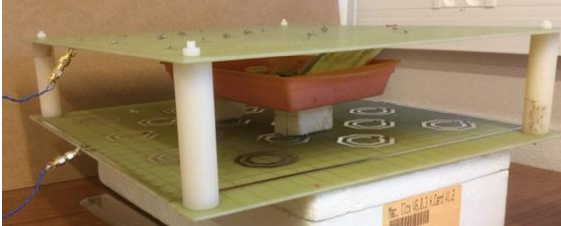
Figure IV. 9: Structure antenne carrée avec résonateur : sur un étage (a) et sur deux étages (b)
