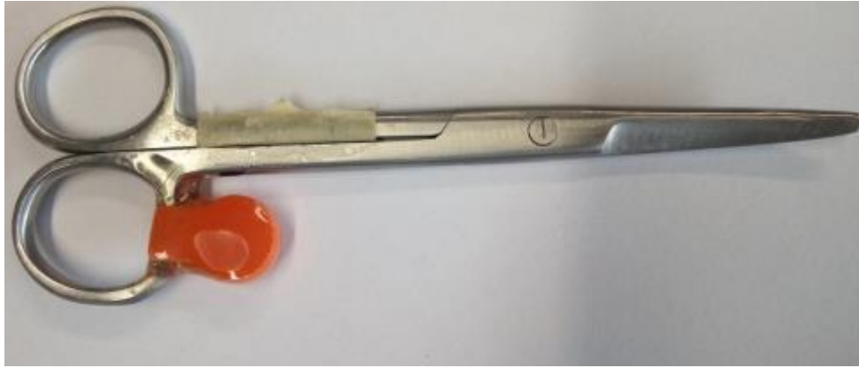
Figure IV. 8 : encapsulation du tag associé à un instrument chirurgical
