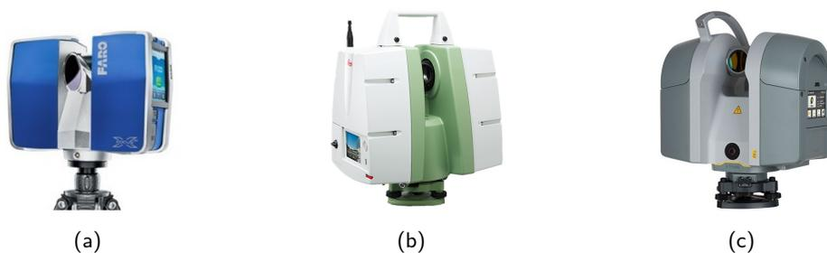
**Figure 1.6** - Exemples de scanners laser terrestres utilisés lors des acquisitions relatives à ces travaux de thèse : (a) FARO Focus<sup>3D</sup> X330 (temps de vol *direct*), (b) Leica ScanStation C10 (décalage de phase), et (c) Trimble TX8 (temps de vol, selon une technologie mixte propre au constructeur)<sup>2</sup>.
