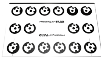
Figure A.1 - Plaque d'étalonnage fournie avec le scanner à main FARO Freestyle 3D .
