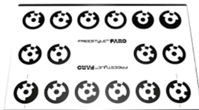
**Figure A.1** - Plaque d'étalonnage fournie avec le scanner à main FARO Freestyle<sup>3D</sup>.
