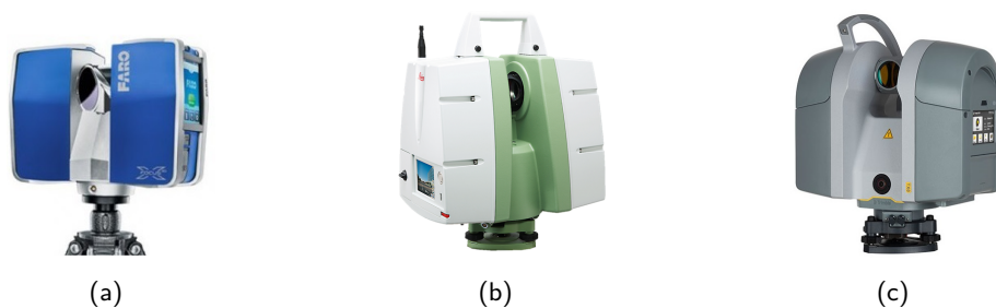
Figure 1.6 - Exemples de scanners laser terrestres utilisés lors des acquisitions relatives à ces travaux de thèse : (a) FARO Focus 3D X330 (temps de vol direct ), (b) Leica ScanStation C10 (décalage de phase), et (c) Trimble TX8 (temps de vol, selon une technologie mixte propre au constructeur) 2 .
