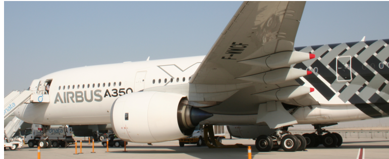
FIGURE 1 – Airbus A350 XWB équipé du turboréacteur Trent XWB de Rolls-Royce présentant un taux de dilution de 9.5 ( https://www.flickr.com/photos/rolls-royceplc ).
